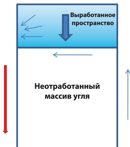
Диаграмма 4.2 Традиционная система проветривания по U-образной схеме
