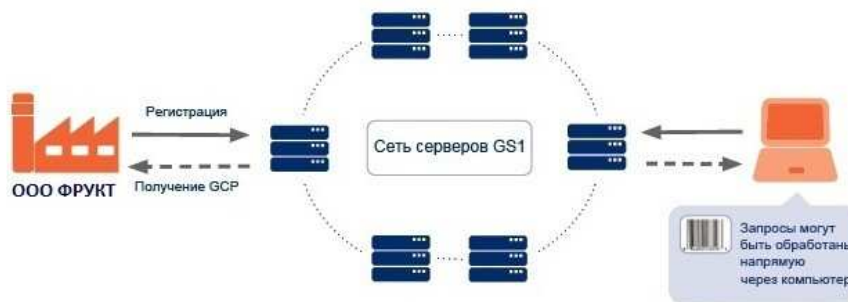
Рис.7.2.2 Принцип, демонстрирующий основные функции GEPIR.
