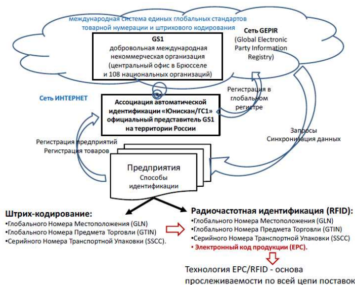
Рис.7.2.1 Система автоматической идентификации на платформе GS1.
