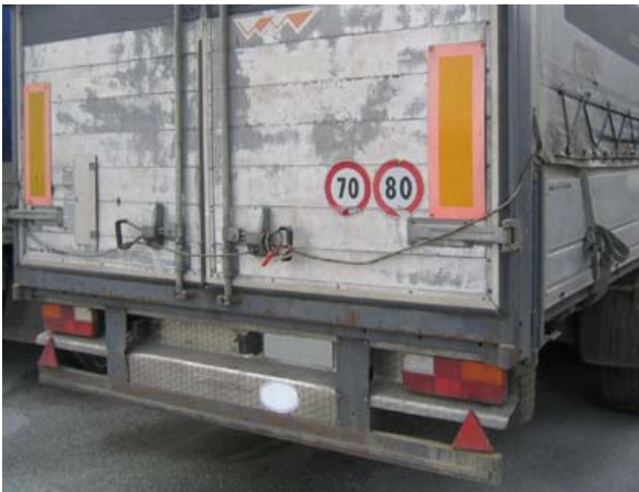
A. Les conditions normales sont remplies: la sécurité et le scellement sont apparemment acceptables.
