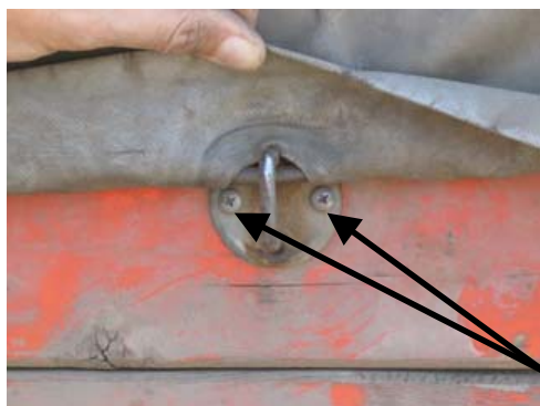
Anneau TIR fixé uniquement au moyen de vis
