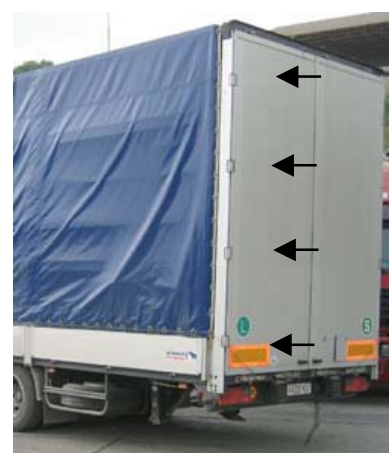
E. Remorque en bon état: aucun dommage aux charnières des panneaux latéraux ou de la porte arrière.
