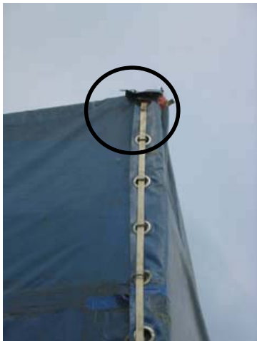
A. Lanière fixée à l'extérieur (au moyen de rivets).
