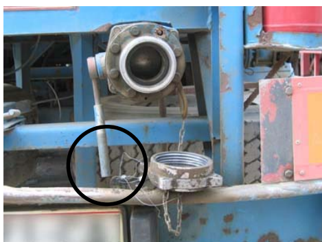
C. Boulon et plaque démantelés: ils ne sont plus attachés à l'embout que par les ficelles et les scellements.
