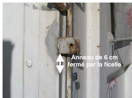
B. Scellement et dispositif de scellement. À noter la longueur de la ficelle: le nœud fait environ 6 cm.
