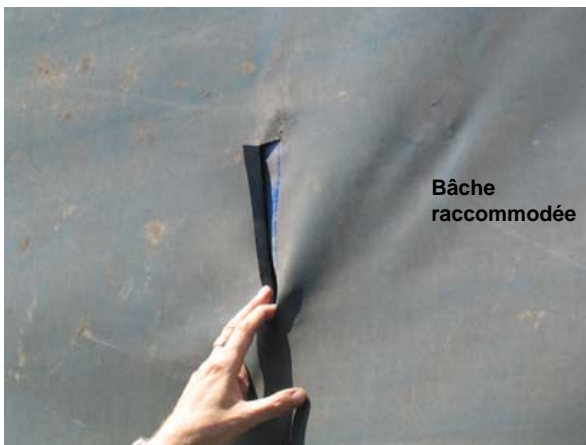
B. Bâche déchirée durant le voyage, dégât mineur. Selon la marchandise transportée, cette remorque POURRAIT être autorisée à terminer le voyage déjà commencé, mais NE devrait PAS être autorisée à effectuer d'autres transports internationaux sans réparation.
