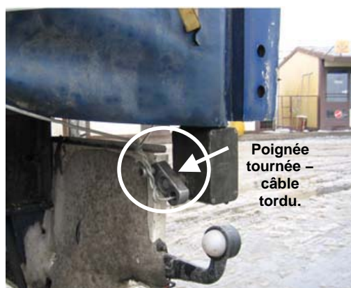
D. Lorsque l'on tourne la poignée, ce câble, trop long, se tordra et la barre de tension pourra être soulevée de sa base.
