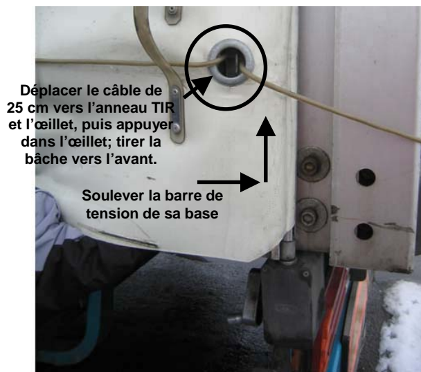
C. Le câble a été déplacé de 25 cm et un nœud a été introduit dans l'œillet. La bâche et l'œillet ont été avancés puis détachés de l'anneau TIR. À présent, il suffit de tourner la poignée, de relâcher la barre de tension et de la soulever de sa base.
