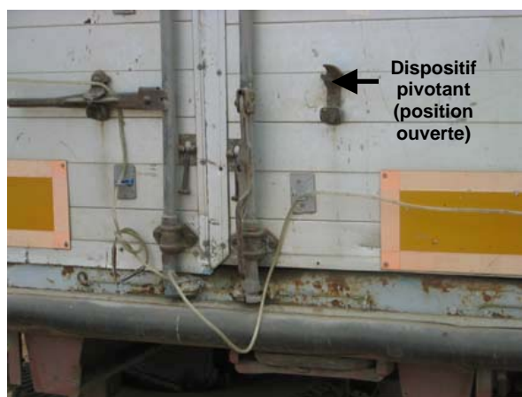
B. Dispositif pivotant ouvert, poignée et tringle de crémone déverrouillées.
