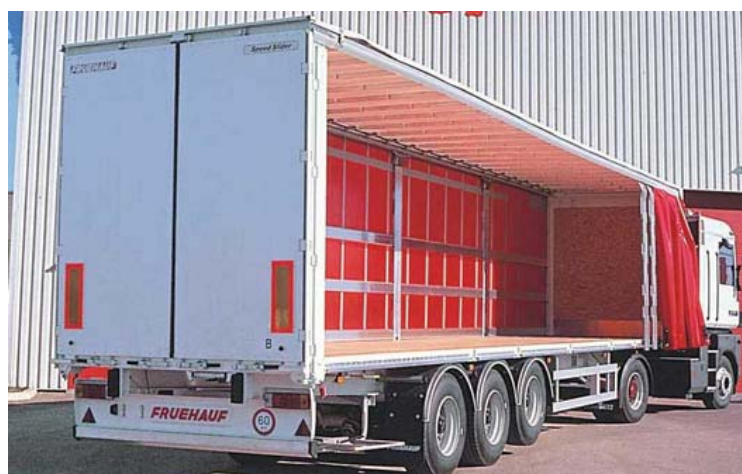
B. Camion à rideaux latéraux, ouvert: Accès facile pour le chargement et le déchargement.
