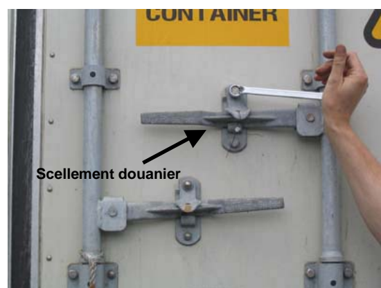
B. Il suffit d'enlever un boulon.
