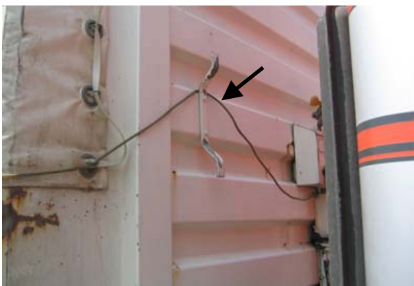
A. Câble TIR accroché à proximité du boîtier de jonction.
