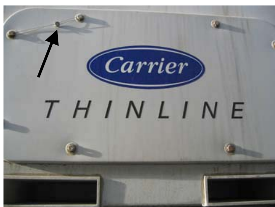
C. Deux exemples de trappes scellées faisant partie de l'unité isotherme.
