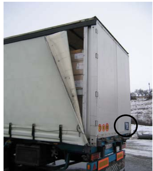
D. Accès limité, mais tout de même inacceptable, au chargement. À noter la plaque d'agrément TIR.
