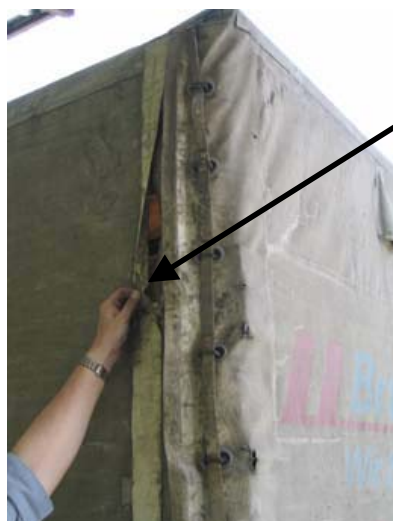
C. Bâche réparée uniquement avec un ruban adhésif. Méthode de réparation non autorisée (artisanale).
