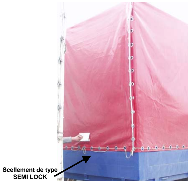
C. Bien que non sécurisé, ce véhicule a été scellé (scellement de type SEMI LOCK).
