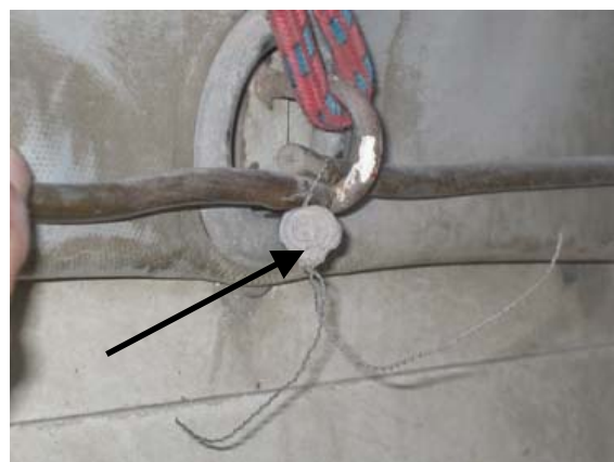
D. Une méthode plutôt inhabituelle de raccommoder un câble sectionné: raccommodé derrière la cabine à l'aide d'un SCELLEMENT DOUANIER.
