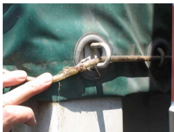
B. En enlevant le ruban adhésif, on constate que le câble TIR a été raccouplé.
