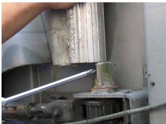
C. Lorsque la barre de tension est délogée, il est facile de la soulever de sa base et d'avoir accès au chargement.
