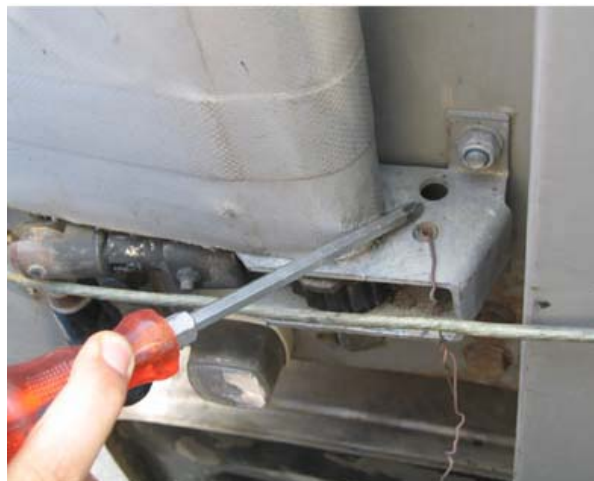
B. Le câble TIR ne passe pas par les orifices spécifiés pour le blocage du cliquet.
