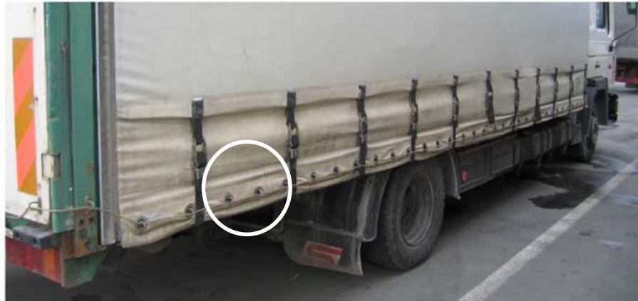
A. Bâche coulissante fixée au moyen d'anneaux TIR soudés au châssis, d'œillet du même nombre et, enfin, d'un câble TIR.
