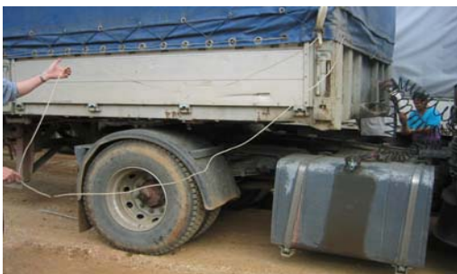
C. Câble TIR, longueur supplémentaire dissimulée et très mal camouflée.
