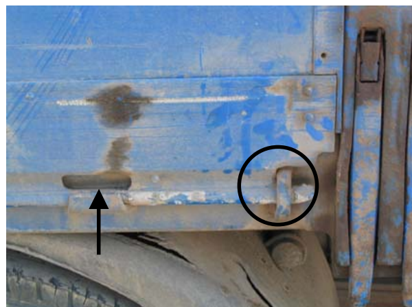
B. La charnière «ouverte», le solide anneau métallique et la poignée de manœuvre verticale du système de fermeture.
