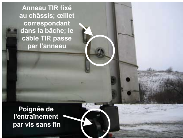
A. Mesure de sécurité: anneau TIR et œillet correspondant dans la bâche.
