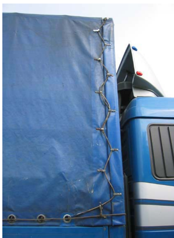
B. Pas de lanière: seulement une corde élastique et des crochets (vue avant du camion).
