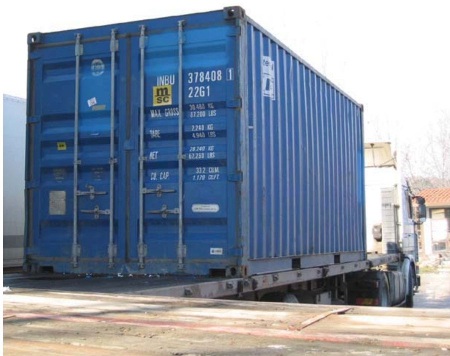
A. Conteneur 20 pieds standard placé sur une remorque. Le conteneur n'a que des portes.
