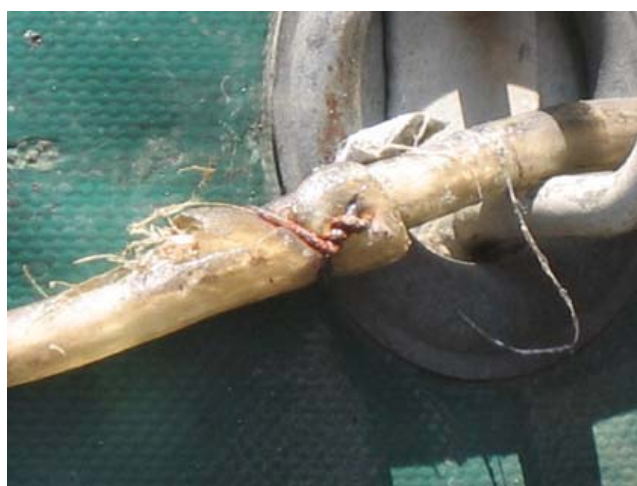
C. Câble TIR raccouplé à l'aide d'un fil de fer simplement tordu et facile à remplacer.
