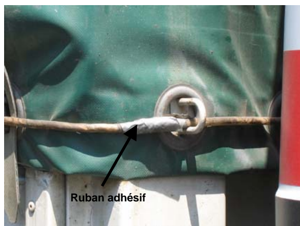
A. Câble TIR entouré d'un ruban adhésif (camouflage).
