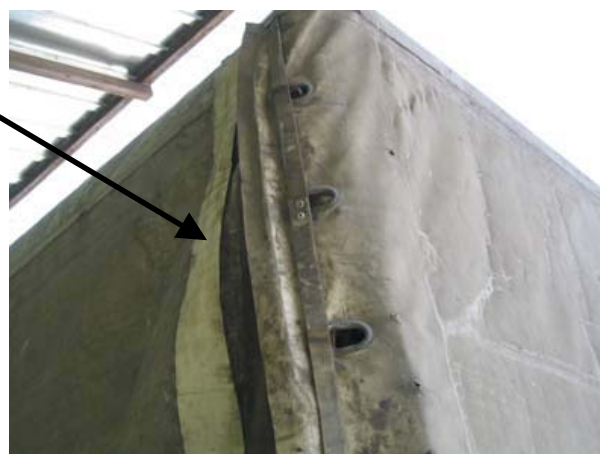
D. Il est très facile d'avoir accès au compartiment réservé au chargement.
