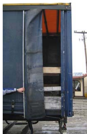
F. La barre de tension est désengagée et le chargement est accessible.
