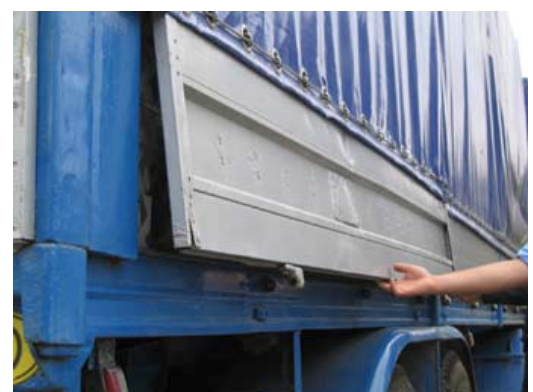
D. Accès limité, mais tout de même inacceptable, au compartiment réservé au chargement.
