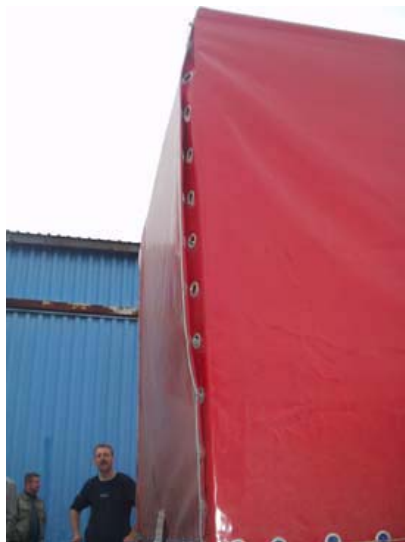
A. On compte sept anneaux TIR par lesquels la lanière ne passe pas.
