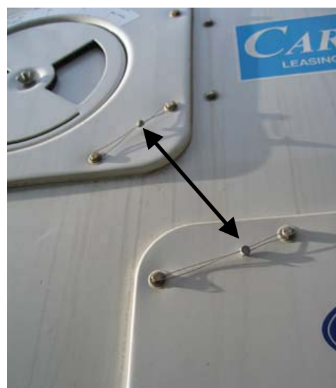
C. Deux exemples de trappes scellées faisant partie de l'unité isotherme.
