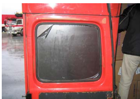
D. Porte arrière: cette fenêtre n'est pas sécurisée, la feuille plastique adhésive ne faisant que diminuer la visibilité.
