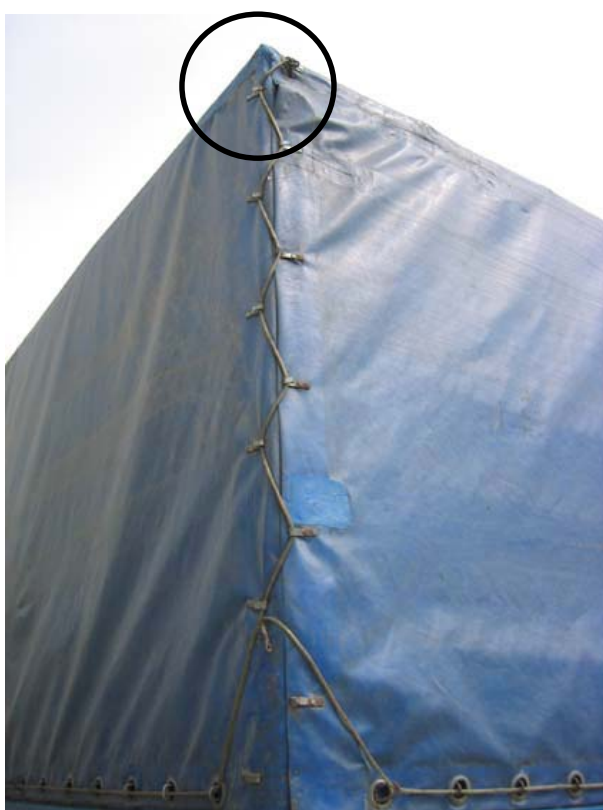
A. Aucune lanière: seulement une corde élastique et des crochets. Il est à noter que la corde n'a même pas la longueur requise (vue arrière du camion).
