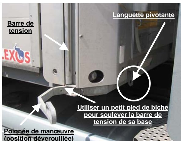
B. Le système est en position OUVRETE. La poignée de manœuvre est tirée et la bâche est relâchée. Il est à présent possible de soulever la barre de tension de sa base.
