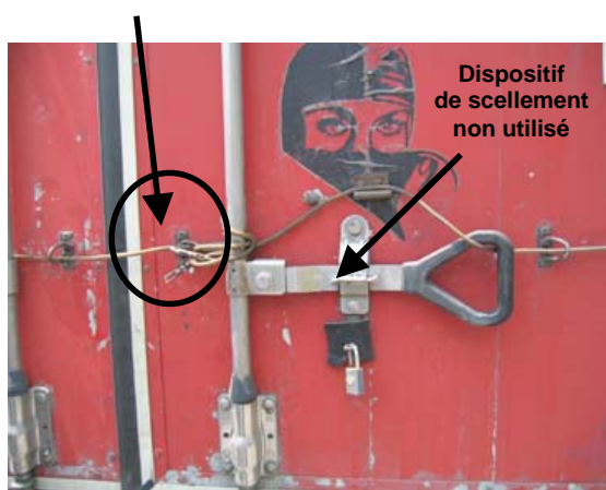
A. Dispositif pivotant NON scellé, bien qu'il soit muni d'un orifice spécifique pour le scellement douanier.
