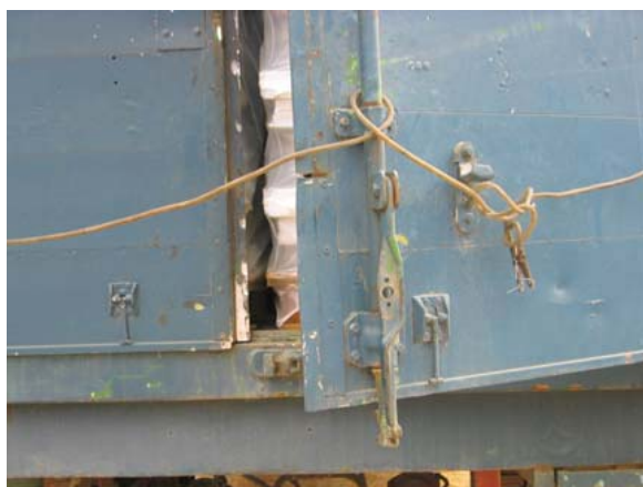
C. Câble TIR trop long et poignée de manœuvre non fixée. Le câble ne passe même pas par l'orifice du dispositif pivotant et de la poignée de la manœuvre.
