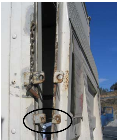
D. Activation du système hydraulique: la rampe est ouverte autant que possible sans qu'il y ait rupture du scellement.
