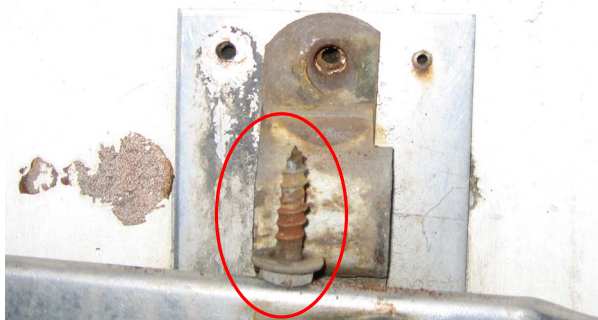
D. La partie pivotante est fixée à l'aide d'un boulon normalement réservé pour le bois. On peut facilement enlever le boulon et abaisser la partie pivotante qui reste fixée à la plaque de fixation grâce à la ficelle du scellement douanier. La poignée est libre et peut être manœuvrée, ce qui permet d'ouvrir la porte.
