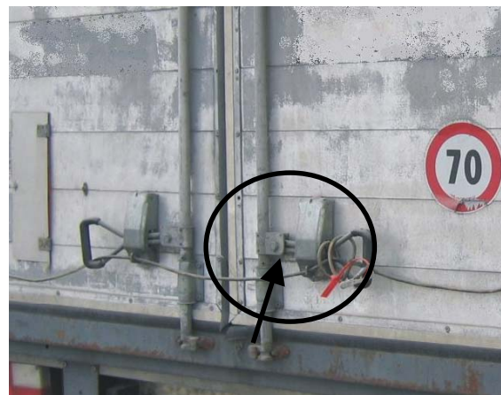
B. Dispositif du boîtier métallique recouvrant le dispositif pivotant attaché par le câble TIR scellé.
