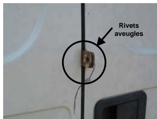
B. Dispositif de scellement de portes arrière: uniquement fixé au moyen de rivets aveugles.
