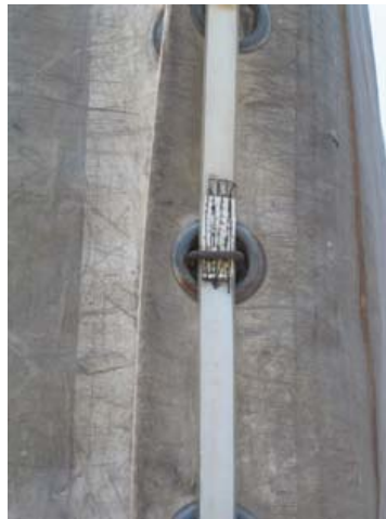
B. Lanière raccommodée ou fixée au moyen d'une couche de textile supplémentaire et cousu.
