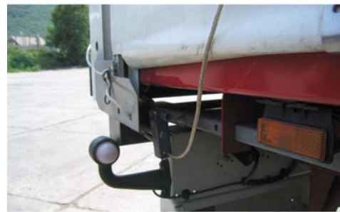
C. Mesure de sécurité: plaque métallique fixée par le câble TIR bloquant la poignée du tendeur (de type «entraînement par vis sans fin»).
