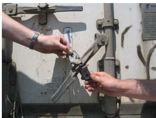
D. Plaque de fixation et dispositif pivotant enlevés.
