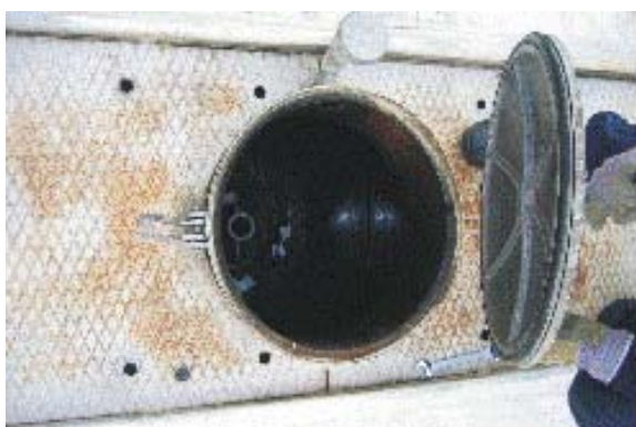
C. Boulon central enlevé et poignée dégagée de l'axe principal.
