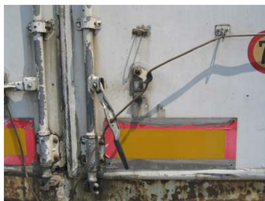
D. Poignée de manœuvre en position libre: la porte peut s'ouvrir.
