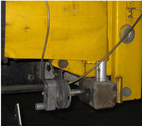
Dispositif tenseur monté sur le véhicule TIR: offre une bonne sécurité.
