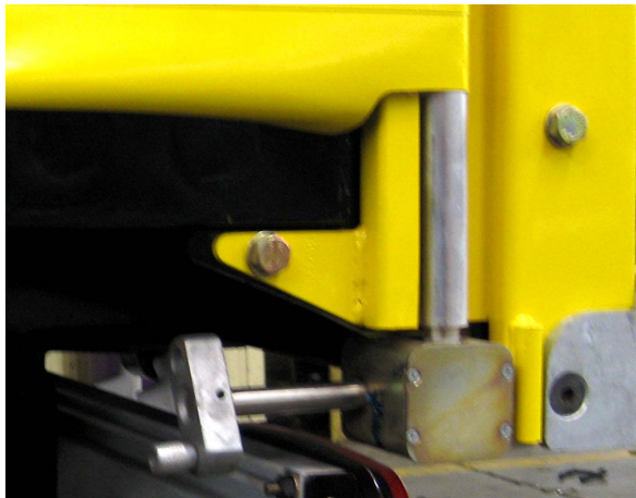
Tendeur monté sur un véhicule standard: n'offre aucune sécurité!
