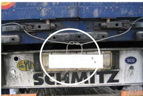
A. Le câble TIR est beaucoup trop long au niveau du point de scellement.
