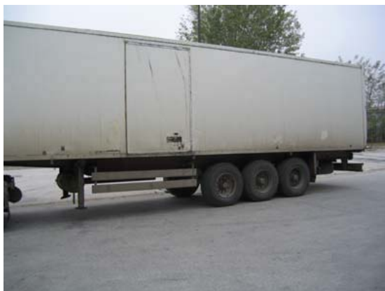
A. Remorque isotherme munie d'une porte latérale.
