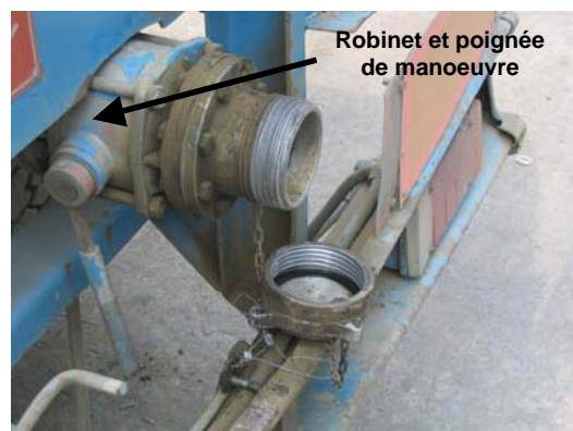
D. Boulon enlevé: il est à présent possible de décharger en actionnant simplement le robinet.
