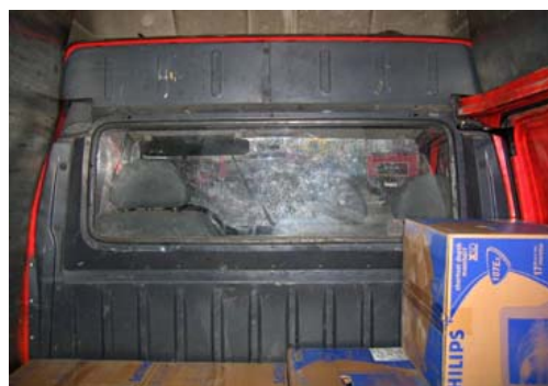
C. Fenêtre entre la cabine et le compartiment réservé au chargement: fenêtre non sécurisée.
