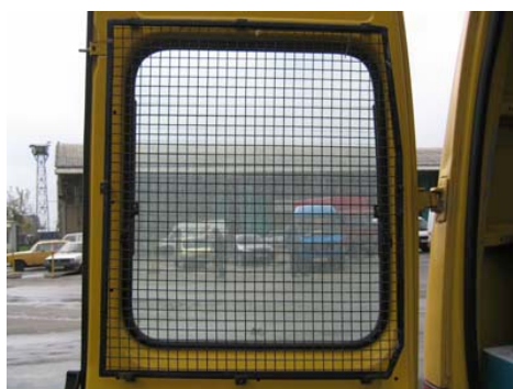
A. Porte arrière: fenêtre sécurisée au moyen d'un grillage métallique.
