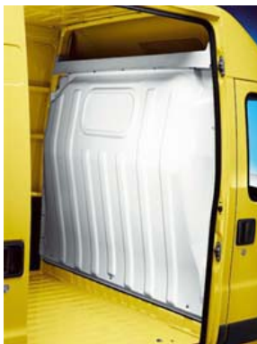
B. Paroi intérieure entre la cabine et le compartiment de chargement.
