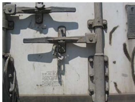
C. Écrou supérieur enlevé; le dispositif pivotant reste fixé à la poignée et à la plaque de fixation.
