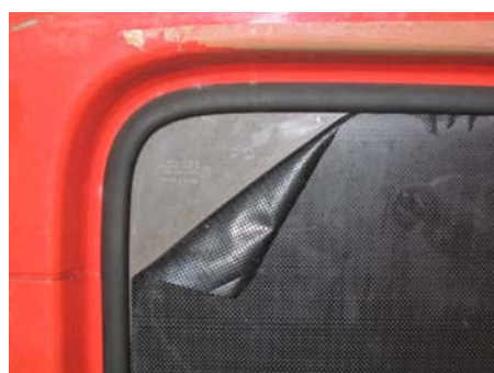
E. Vue détaillée d'une feuille plastique adhésive.
