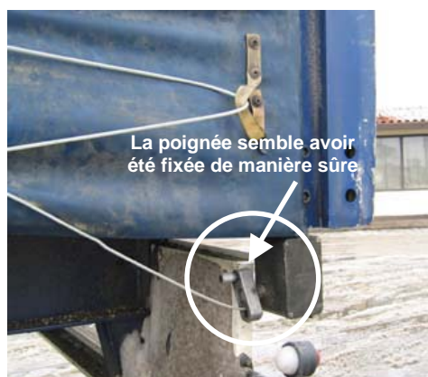
C. La poignée semble avoir été fixée de manière sûre: le câble passe à travers elle.
