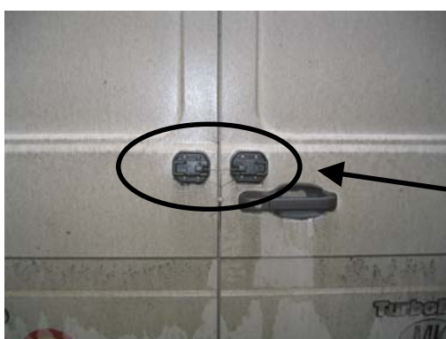
C. Dispositif de scellement de fabrication artisanale: les deux morceaux de plastique sont fixés au moyen de vis ordinaires
