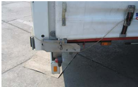
B. Mesure de sécurité: une plaque métallique bloque la poignée du tendeur (de type «entraînement par vis sans fin»).
