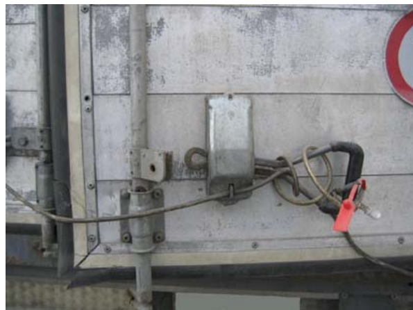
D. Poignée déconnectée, tringle de crémone tournée, la porte s'ouvre! Il est facile de remettre le tout comme avant
