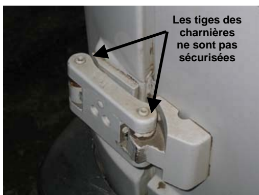
C. Dispositif de scellement de fabrication artisanale: les deux morceaux de plastique sont fixés au moyen de vis ordinaires
