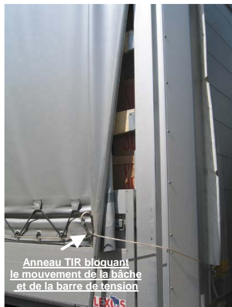
C. Barre de tension soulevée de sa base. Le premier anneau TIR fixé sur la paroi bloque la barre de tension et la bâche peut être déplacée de plus de 25 cm, ce qui est suffisant pour accéder au compartiment réservé au chargement.
