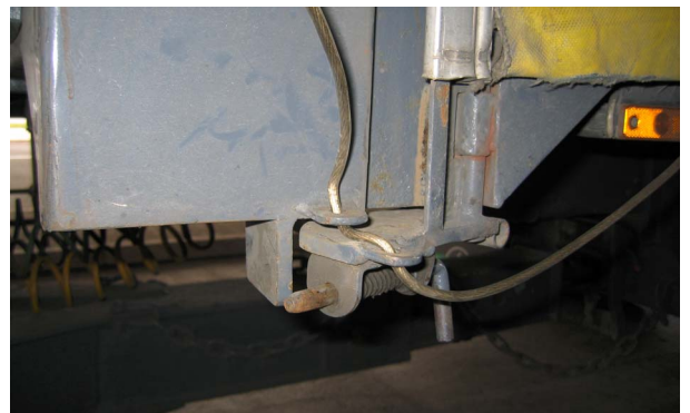
C. L'écart important permettra de faire passer le câble TIR et d'écarter le profil en aluminium et la bâche.
