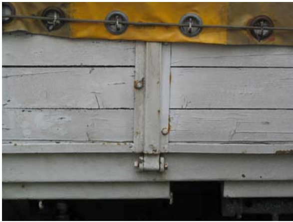
A. Charnière de panneau peu sûre (véhicule de type ancien).
