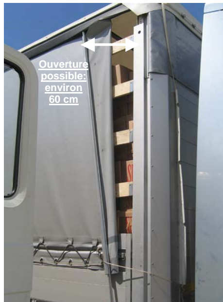
D. Barre de tension soulevée de sa base. Bien que l'anneau TIR bloque la barre de tension, la partie supérieure de la bâche peut être écartée d'environ 60 cm, ce qui donne une ouverture non négligeable.
