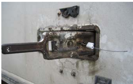
E. Le scellement de type «semi-lock» reste hors de la poignée. Il est à présent possible de tirer sur la poignée et d'ouvrir la porte.
