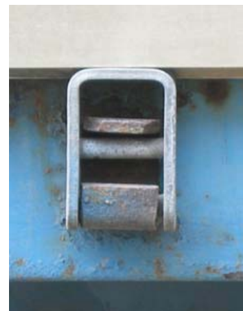
C. Charnière «à fixation automatique» – panneau latéral (l'ancienne version).
