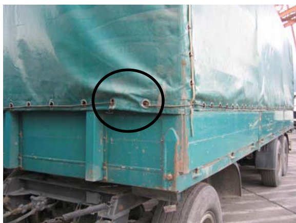
A. Câble TIR dissimulé derrière la bâche.
