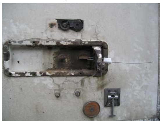
C. Le câble peut passer à travers le dispositif de scellement et la poignée peut être dégagée selon un angle pouvant atteindre 75°.
