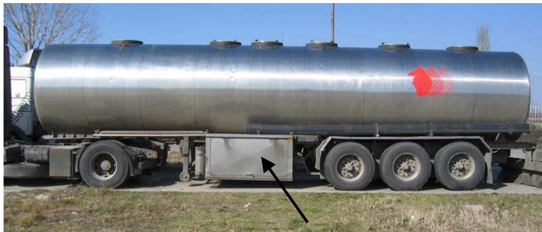
A. Citerne munie d'un compartiment spécial.
