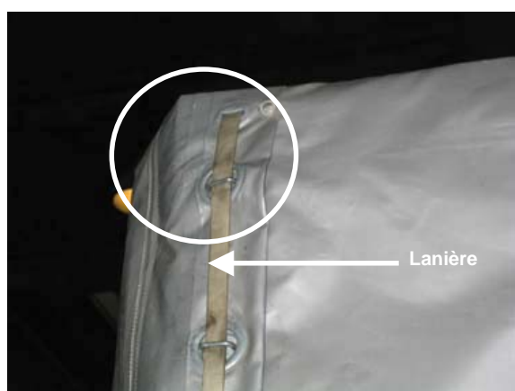
A. Lanière introduite dans un trou spécial afin qu'elle passe à travers toutes les couches de la bâche (coin supérieur avant de la remorque).
