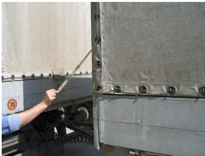
B. Il est facile d'enlever la lanière et d'avoir accès au chargement.
