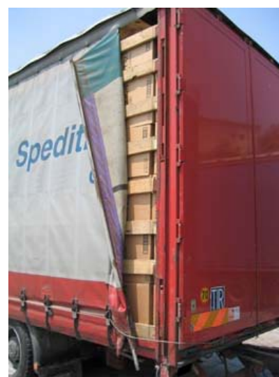
B. Le système est désengagé: la barre de tension est soulevée de sa base et la bâche est ouverte de 50 cm.
