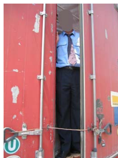
D. Porte ouverte: il est facile d'accéder au compartiment.
