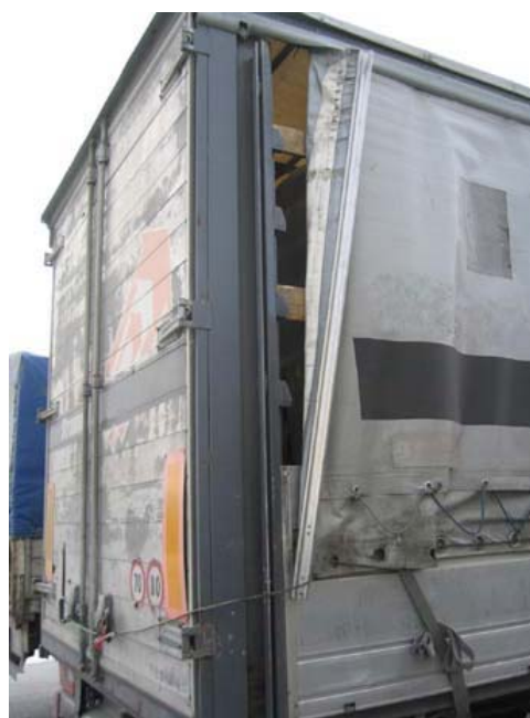
C. On peut avoir accès au chargement: il est possible de faire coulisser la bâche de 80 cm.
