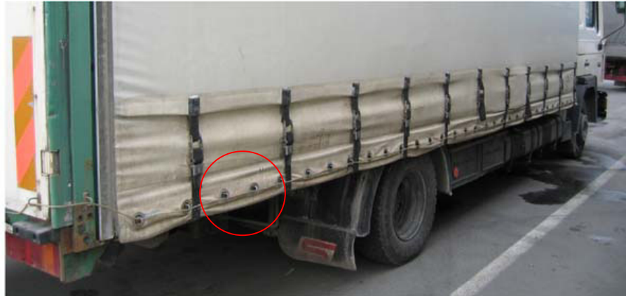
А: Скользящая по́ла закреплена с помощью колец МДП, приваренных к шасси. По́ла имеет соответствующие проушины и в конечном счете закреплена тросом МДП.
