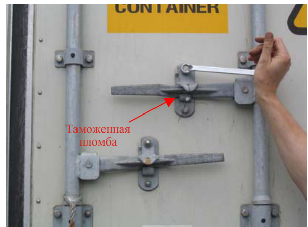
В: Достаточно удалить лишь один болт.
