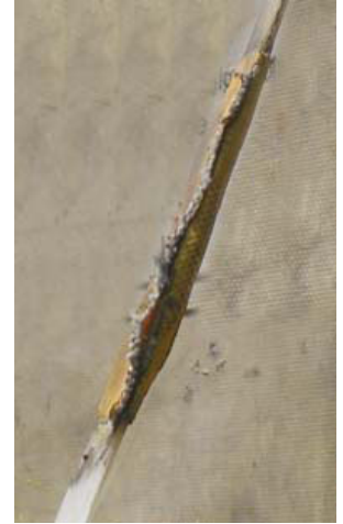
С: Ремень, отремонтированный или склеенный в месте разрыва лентой.
