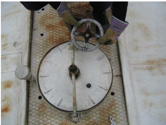
С: Центровочный болт удален: поворотная ручка снята с главной оси.
