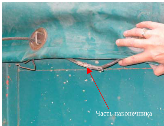
В: Соединенный трос МДП: используется часть наконечника.
