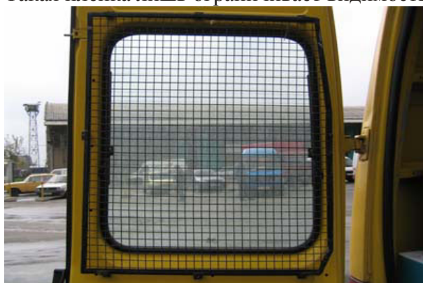
А: Задняя дверь: безопасность окна обеспечивается металлической сеткой.
