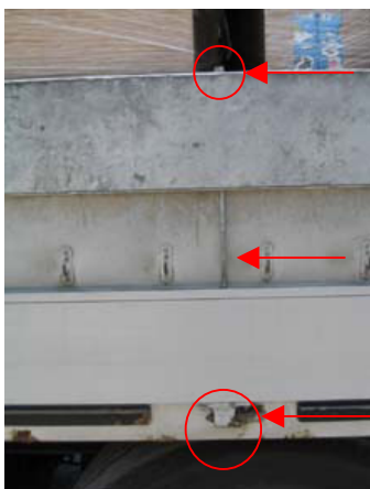
Д: Петля, закрепляющаяся длинным болтом, вставленным через борт. Доступ к болту невозможен, поскольку он закрыт брезентом.
