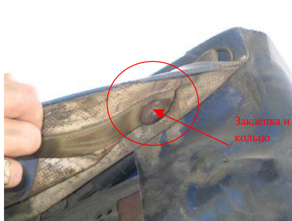
С: Ремень, прикрепленный только к внешнему слою брезента, позволяет без труда заменить заклепку.
