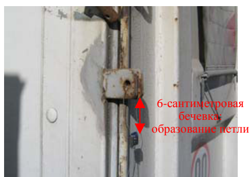
В: Пломба и опечатывающее устройство. Следует обратить внимание на слишком большую длину бечевки. Из-за этого образуется петля длиной около 6 см.
