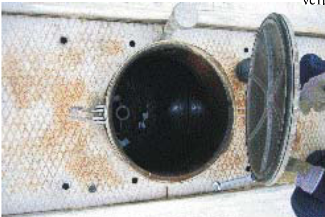
С: Центровочный болт удален: поворотная ручка снята с главной оси.
