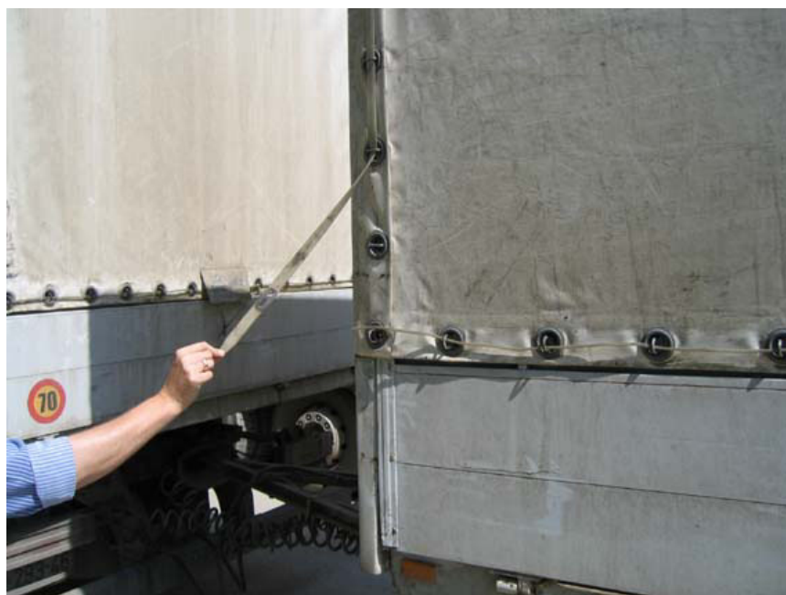
В: Можно легко снять/ослабить ремень и получить доступ к грузу.
