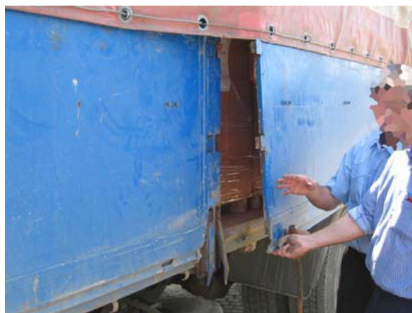
Д: Следует разблокировать запирающую систему, приподнять борт над петлей и обеспечить доступ к грузовому отделению.
