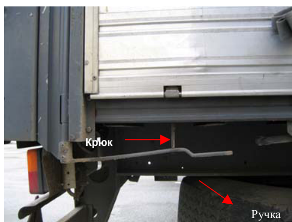
А: Система "быстрого разблокирования", ручка и крюк (основание): систему весьма легко привести в действие.
