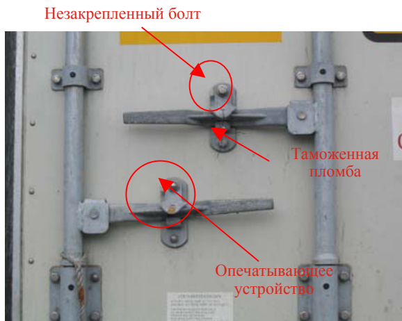
А: Незакрепленное устройство и опломбированная ручка.
