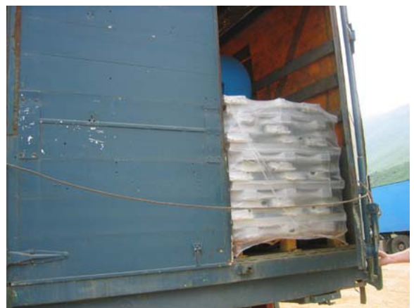
Д: Уже один лишний метр длины троса позволяет широко открыть дверь.
