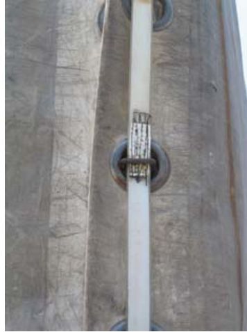
В: Ремень, отремонтированный или сшитый в месте разрыва при помощи куска ткани.
