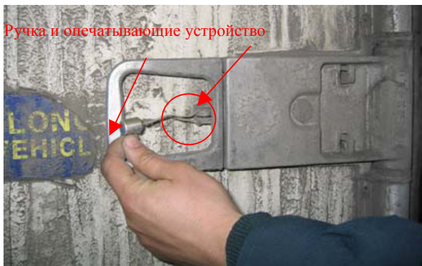
А: Ручка и печатающее устройство слева.
