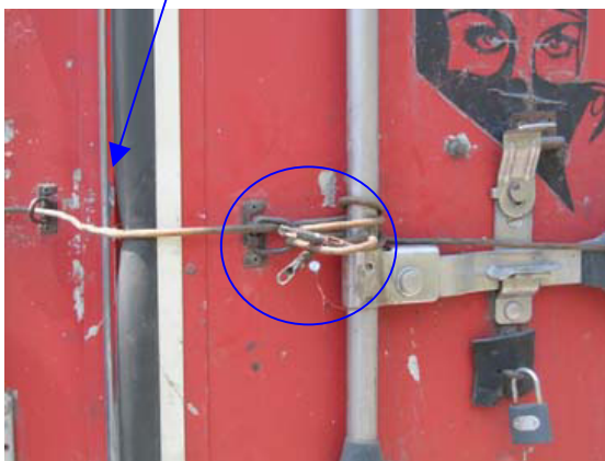
С: Вращающееся устройство в положении "ОТКРЫТО". Достаточно лишь приподнять ручку и повернуть запирающий стержень: уже 40 см лишней длины троса МДП позволяют проникнуть в грузовое отделение.
