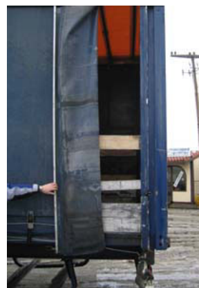
Ф: Натяжной стержень освобожден: имеется доступ к грузу.
