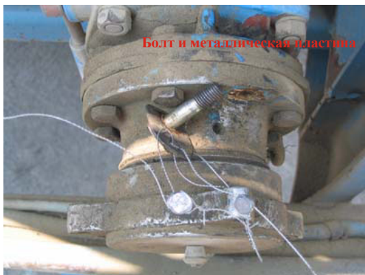
С: Болт и пластина сняты: теперь они присоединены к торцевой крышке только бечевками и пломбами.
