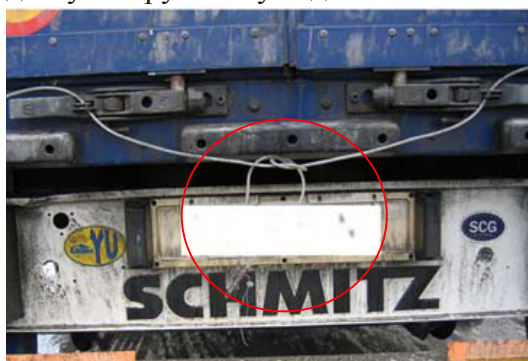
А: Трос МДП слишком длинный в месте опломбирования.
