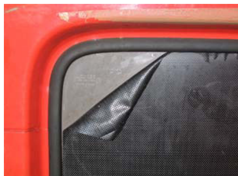
Е: Деталь: липкая затемненная пластиковая пленка.
