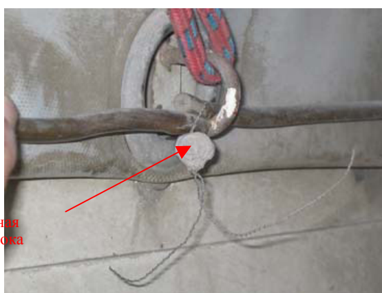
Д: Достаточно необычный способ соединения разорванного или перерезанного троса. Соединение за кабиной водителя при помощи ТАМОЖЕННОЙ ПЛОМБЫ.
