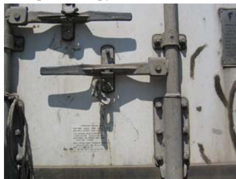
С: Верхняя гайка удалена: поворотное устройство по-прежнему подсоединено к ручке и задней пластине.
