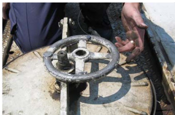
Д: Поворотная ручка снята с главной оси.
