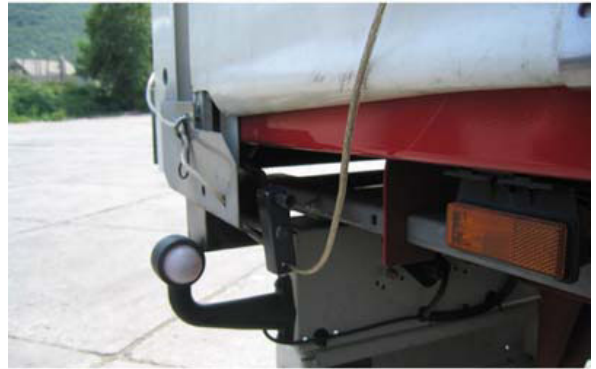
С: Устройство обеспечения безопасности: металлическая пластина, закрепленная с помощью троса МДП, блокирующего ручку натяжного устройства (с червячной передачей).
