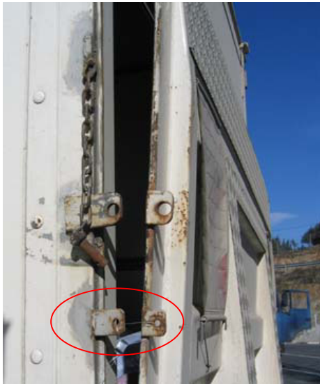
D: Гидравлическая система приведена в действие: платформа открыта максимально широко без повреждения пломбы.
