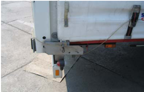
В: Устройство обеспечения безопасности: металлическая пластина, блокирующая ручку натяжного устройства (с червячной передачей).
