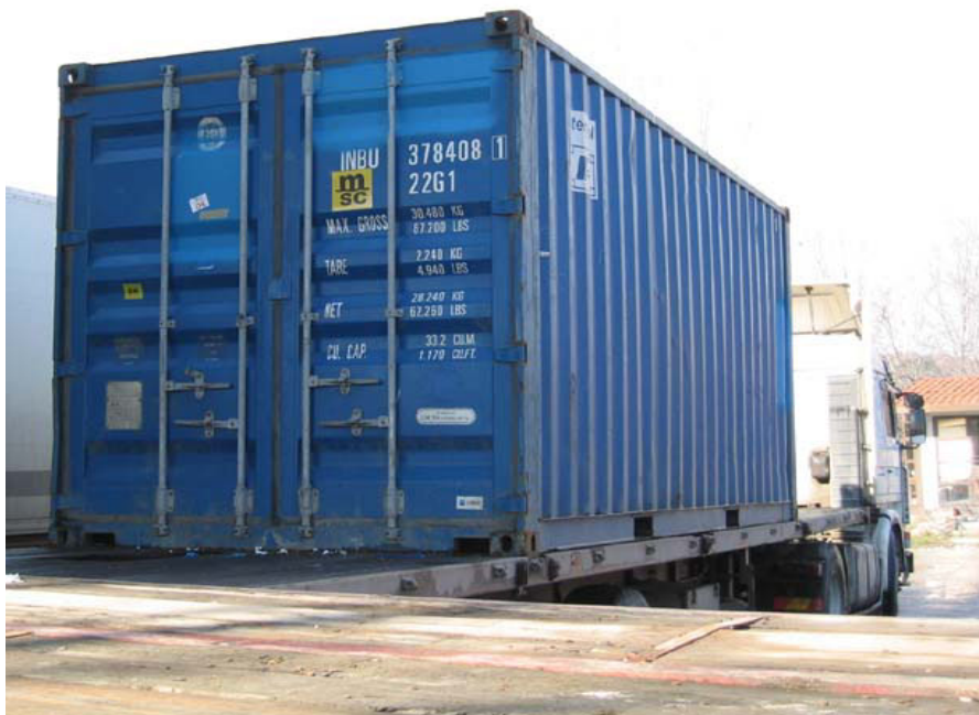
А: Стандартный 20-футовый контейнер, помещенный на прицеп. В контейнере имеются только двери.
