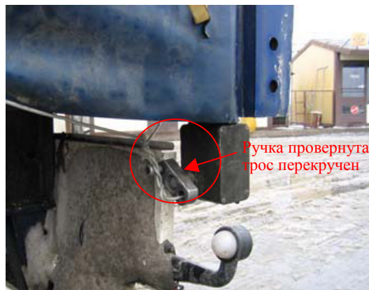
Д: Однако этот излишне длинный трос просто перекручивается при повороте ручки и натяжной стержень можно приподнять над основанием.
