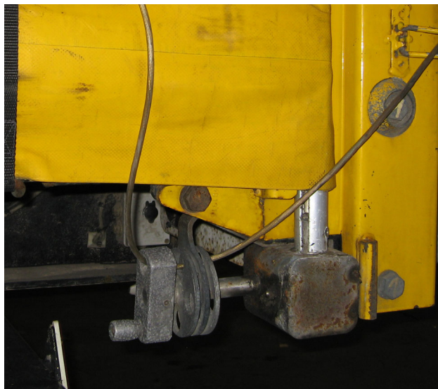
Натяжное устройство, установленное на транспортном средстве МДП и обеспечивающее эффективную защиту.
