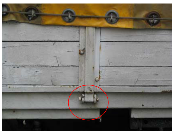
А: Незакрепленная бортовая петля (Грузовой автомобиль, выпускавшийся ранее)
