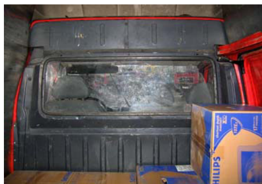
С: Окно между кабиной водителя и грузовым отделением: безопасность окна не обеспечена.
