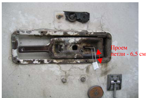
В: Опечатывающее устройство и "полузапирающая" пломба. Следует обратить внимание на 6,5-сантиметровую петлю!
