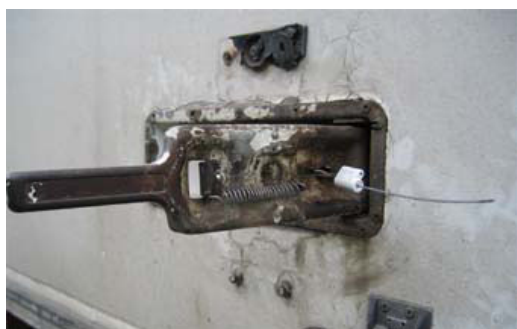
Е: "Полузапирающая пломба" остается снаружи ручки. Теперь можно потянуть за ручку и открыть дверь.
