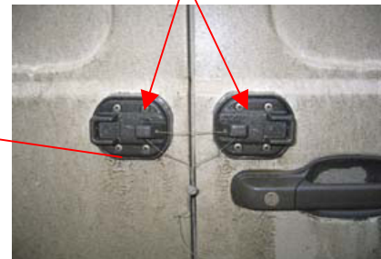
Д: Необходимо удалить только четыре винта, чтобы опечатывающее устройство утратило эффективность.
