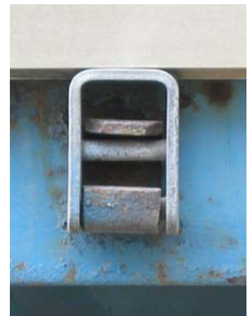
С: "Самозакрепляющаяся" петля: борт. (Устаревшая модель)
