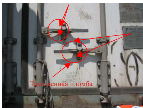
А: Незакрепленное устройство и опломбированная ручка.
