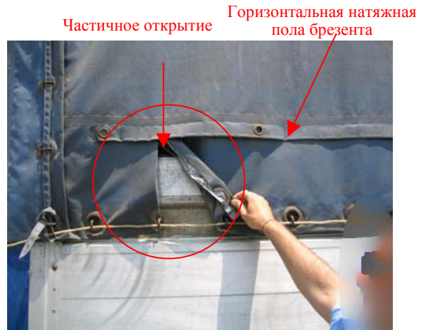
В: Ограниченный доступ к грузовому отделению. В зависимости от характера перевозимого груза прицеп может быть допущен к завершению текущей перевозки. Следует обращать внимание на натяжную полку брезента, так как в этом месте повреждение может находиться с обратной стороны натяжной полки.
