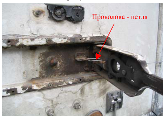
Д: Проволока может проходить через отверстие за ручкой (с внутренней стороны).
