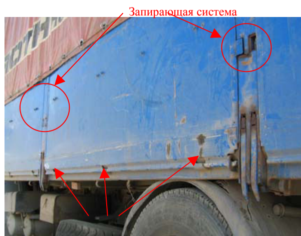
А: "Открытые" петли: борт закреплен только запирающей системой и одним металлическим кольцом.
