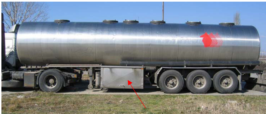
А: Автоцистерна, оснащенная специальной коробкой для системы трубопроводов и клапанов.
