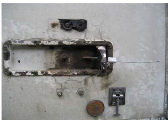
С: Проволока может проходить сквозь опечатывающее устройство, а ручка может быть повернута на 75°.
