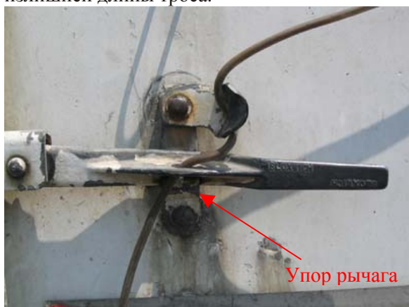
С: Ручку управления легко приподнять над упором.
