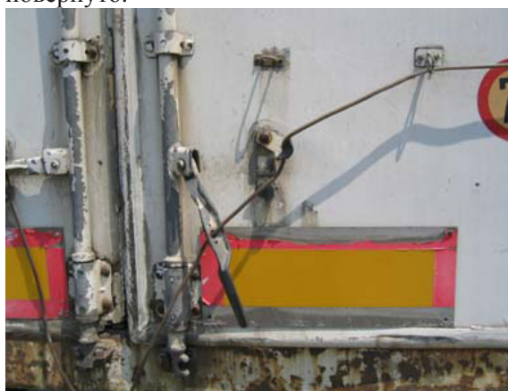
Д: Ручка управления в свободном положении: дверь может быть открыта.
