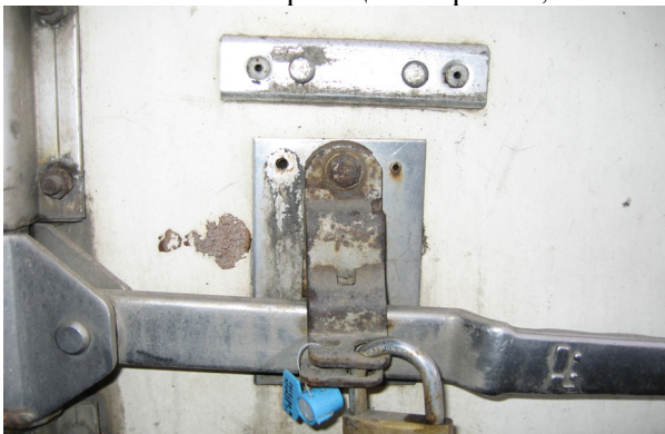
А: Первоначальные устройства, предназначенные для всех запирающих стержней, несомненно, заменены.
