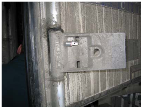
D: Ручка повернута, запирающий стержень приведен в действие, дверь открыта: пломба остается без повреждений.
