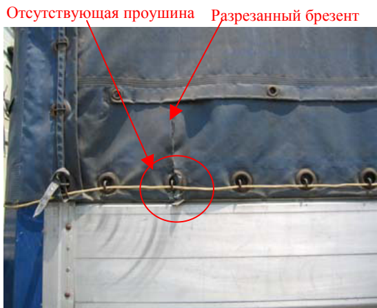
А: Отсутствующая проушина, разрыв брезента - незначительное повреждение (отсутствует только одна, а не несколько проушин в ряду).
