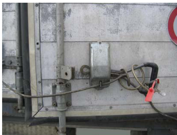
Д: Ручка отсоединена, запирающий стержень повернут, и дверь открылась! И столь же легко данное соединение восстановить!
