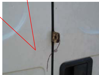
Г: Опечатывающее устройство закреплено сваркой.
