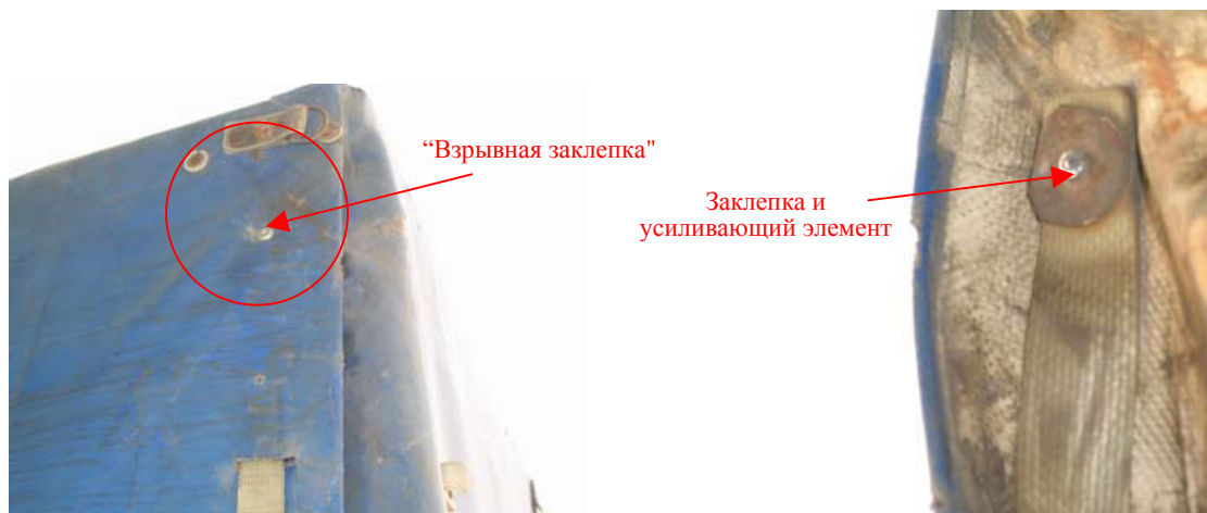
А: Ремень, прикрепленный "взрывной заклепкой". Следует обратить внимание на то, что речь идет о новой заклепке! Вид СНАРУЖИ.
