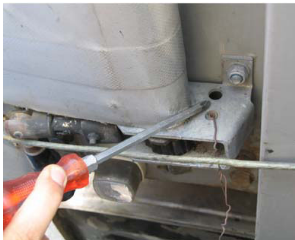
В: Трос МДП не проходит через специальные отверстия, предусмотренные для блокировки собачки храпового механизма.
