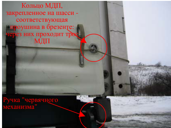
А: Устройство обеспечения безопасности: кольцо МДП и соответствующая проушина находятся в брезенте.
