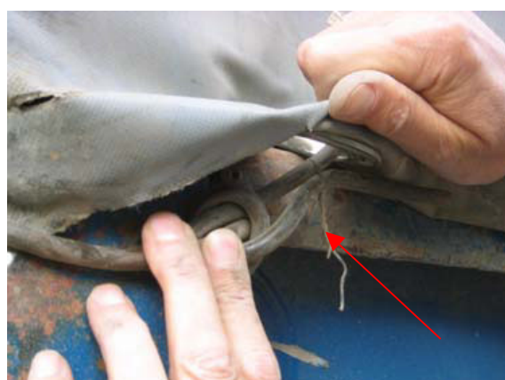
С: Разорванный трос МДП, который отремонтирован посредством скручивания в две петли и закрепления концов тонкой стальной проволокой.
