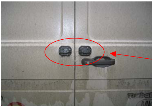
С: Опечатывающее устройство кустарного изготовления: обе пластмассовые пластины закреплены стандартными винтами.
