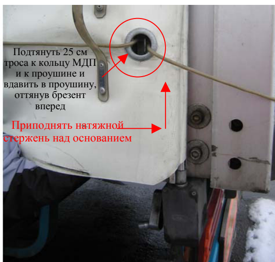
С: Отрезок троса длиной 25 см подтянут, а петля вдавлена в проушину. Брезент и петля оттянуты вперед и сняты с кольца МДП. Теперь достаточно повернуть ручку, ослабить напряжение и приподнять натяжной стержень над основанием.
