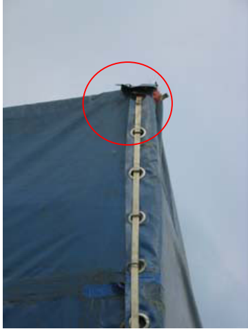
А: Ремень, прикрепленный снаружи (заклепками).
