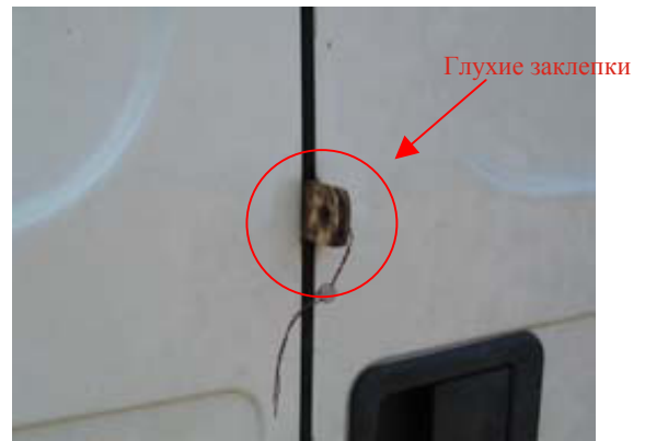
В: Опечатывающее устройство на задних дверях закреплено только глухими заклепками.
