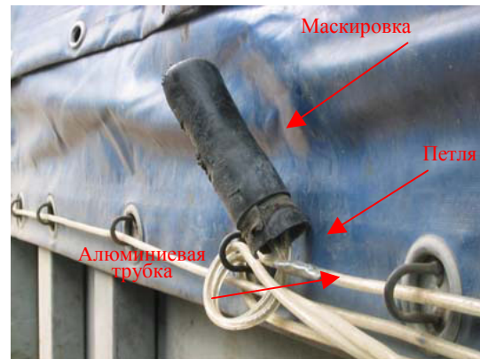
Д: Пластмассовая трубка, используемая в качестве вместилища для загнутого конца петли. Следует обратить внимание на алюминиевую трубку: ремонт перерезанного или разорванного троса.
