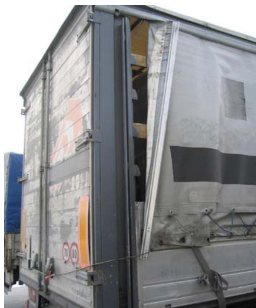
С: Доступ к грузу: можно оттянуть брезент на 80 см.
