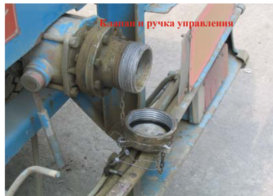
Д: Торцевая крышка снята; теперь можно слить содержимое цистерны - достаточно лишь открыть клапан.
