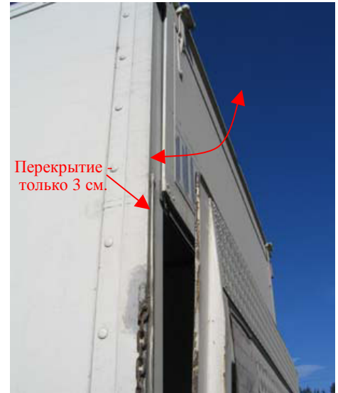
E: Когда платформа приоткрыта, зачастую можно оттянуть (приподнять) деревянную панель и получить доступ к грузу.
