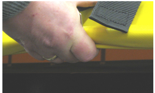
Стандартное транспортное средство: перекрытие составляет всего лишь 1,5 см!
