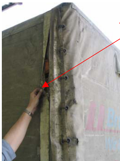
С: Брезент, отремонтированный только с помощью липкой ленты. Несанкционированный (кустарный) ремонт.
