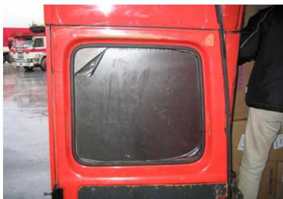
Д: Задняя дверь: безопасность окна не обеспечена; нанесена лишь липкая затемненная пластиковая пленка для ограничения видимости.
