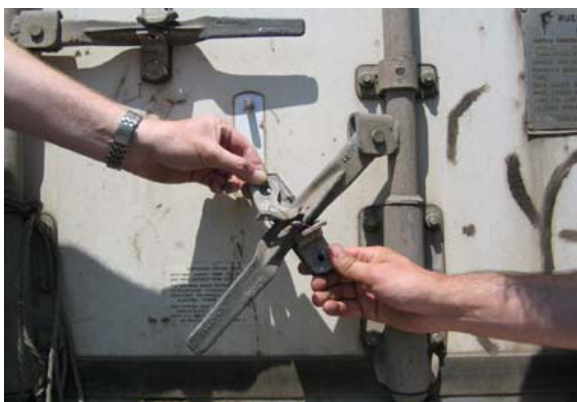
Д: Задняя пластина и поворотное устройство сняты.
