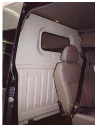
С: Внутренняя перегородка с окном.
