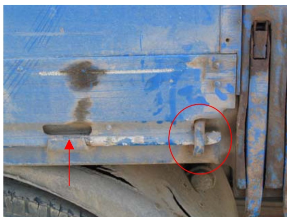
В: "Открытая" петля, прочное металлическое кольцо и ручка управления запирающей системы в вертикальной плоскости.
