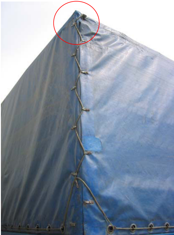
А: Ремень отсутствует: имеется только эластичный трос и крюки. Следует отметить, что даже длина троса является недостаточной. (Вид грузового автомобиля сзади)
