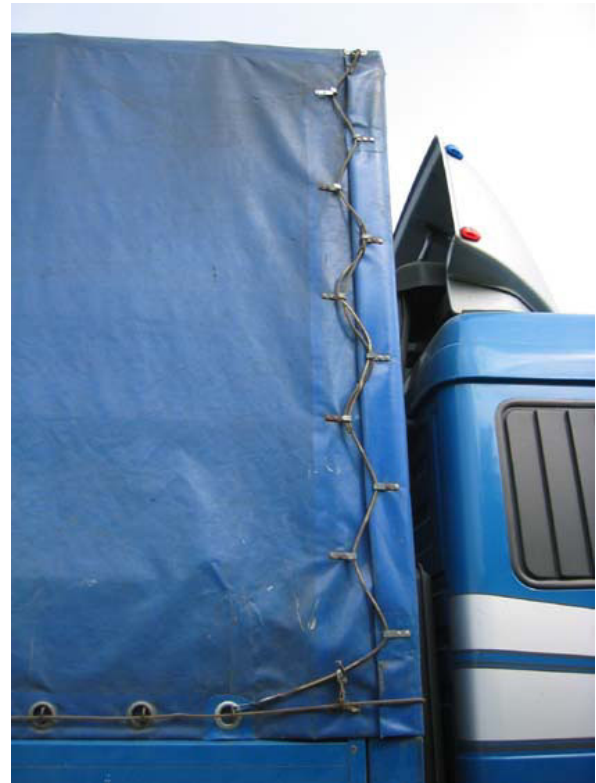
В: Ремень отсутствует: имеется только эластичный трос и крюки. (Вид грузового автомобиля спереди)
