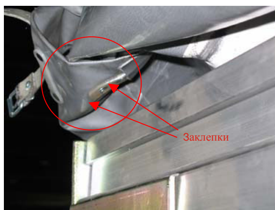
В: Закрепленный ремень установлен на ВНУТРЕННЕМ слое брезента. (Передняя верхняя часть прицепа)
