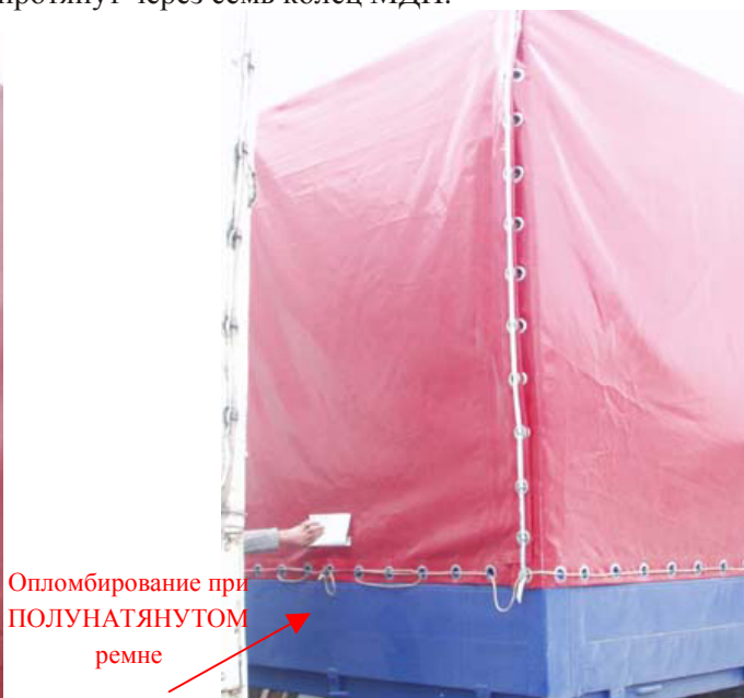
С: Грузовой автомобиль опломбирован, хотя полного закрепление ремня не произведено. (Опломбирование с ПОЛУНАТЯНУТЫМ ремнем)
