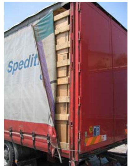
В: Система разблокирована: натяжной стержень приподнят над опорой; брезент приоткрыт на 50 см.
