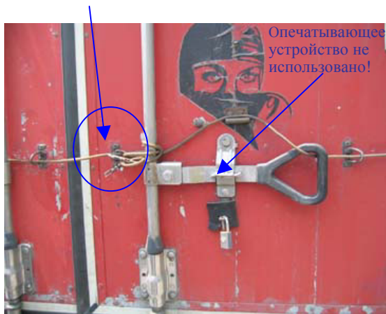
А: Поворотное устройство НЕ опломбировано, хотя в нем имеется конкретное отверстие для наложения таможенной пломбы.
