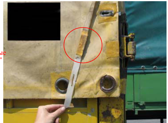
Е: Отремонтированный ремень, склеенный липкой лентой.
