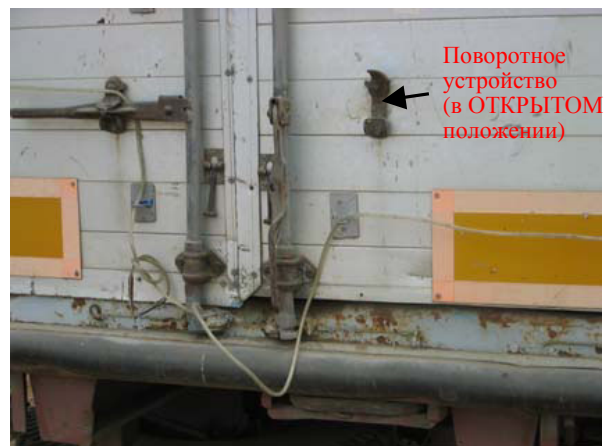
В: Поворотное устройство ОТКРЫТО: ручка управления и запирающий стержень освобождены.
