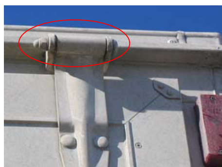
С: Небезопасная петля деревянной панели. Стержень изготовлен из простого стандартного болта с неприваренной к нему глухой гайкой.
