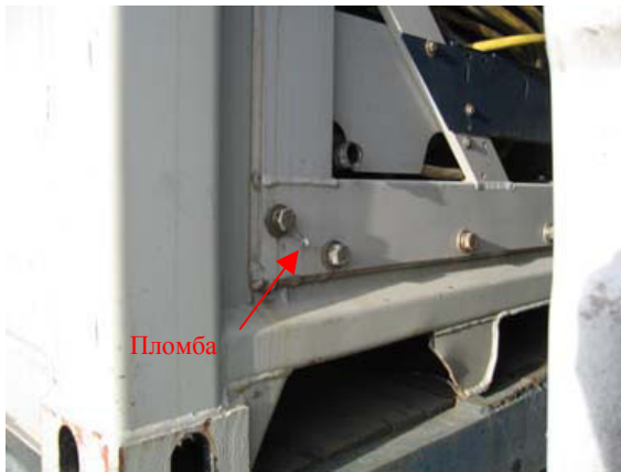
А: Нижняя часть рамы, болты и пломба холодильной установки.
