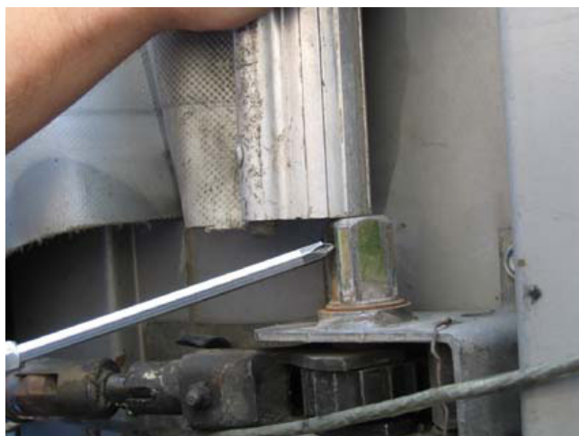
С: Натяжной стержень в освобожденном состоянии может быть легко приподнят над основанием, а это открывает доступ к грузу.
