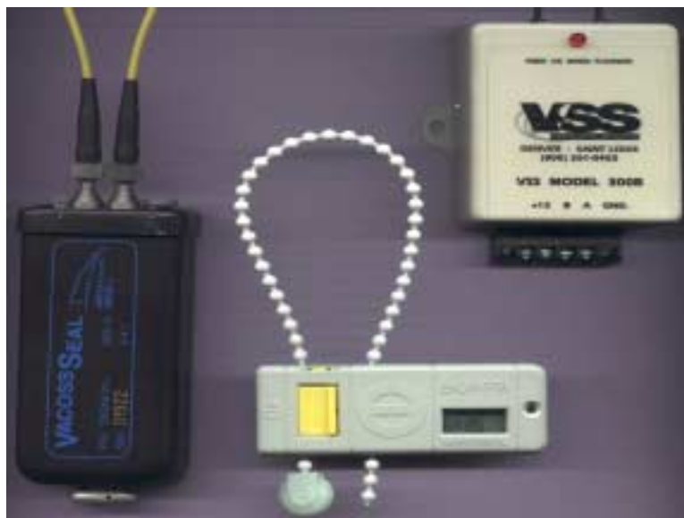
Рис. 7 - Три примера активных пломб.
