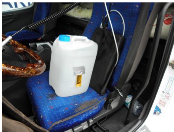
Фотография 1 – «Водяной фантом», моделирующий водителя, и дозиметр на сиденье водителя в кабине сканируемого грузовика.
