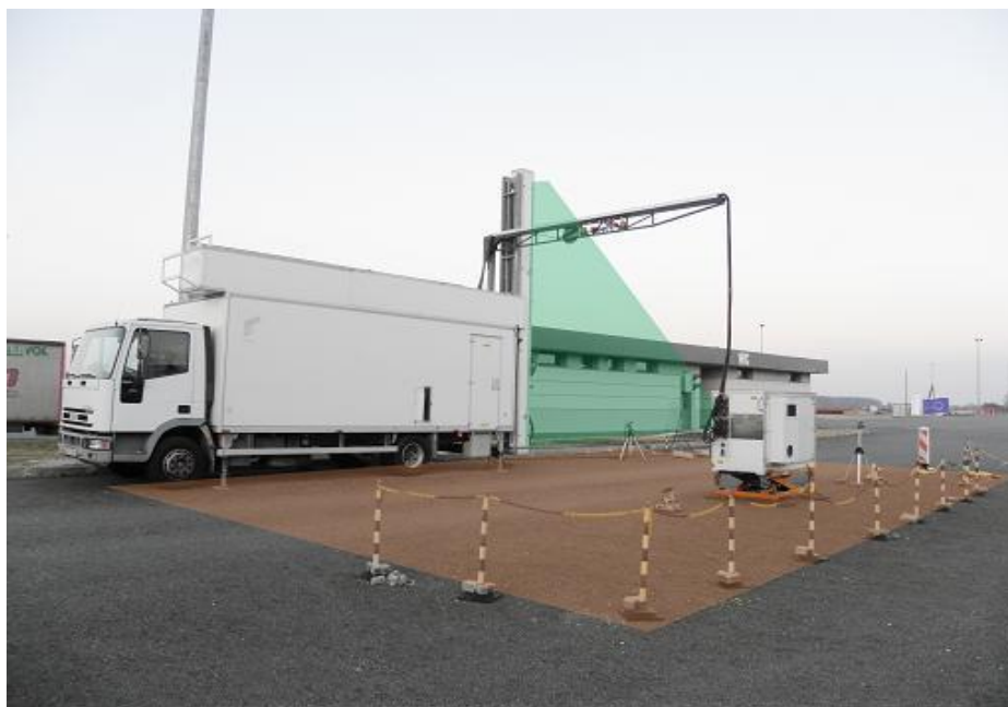
Фотография 3 – Сканиер контурного типа – 300 кэВ: рентгеновский инспекционно-досмотровый комплекс с двумя уровнями энергии, работающий в режиме постоянного воздействия. На фотографии показана зона ограничения доступа вокруг комплекса, работающего в режиме сканирования.
