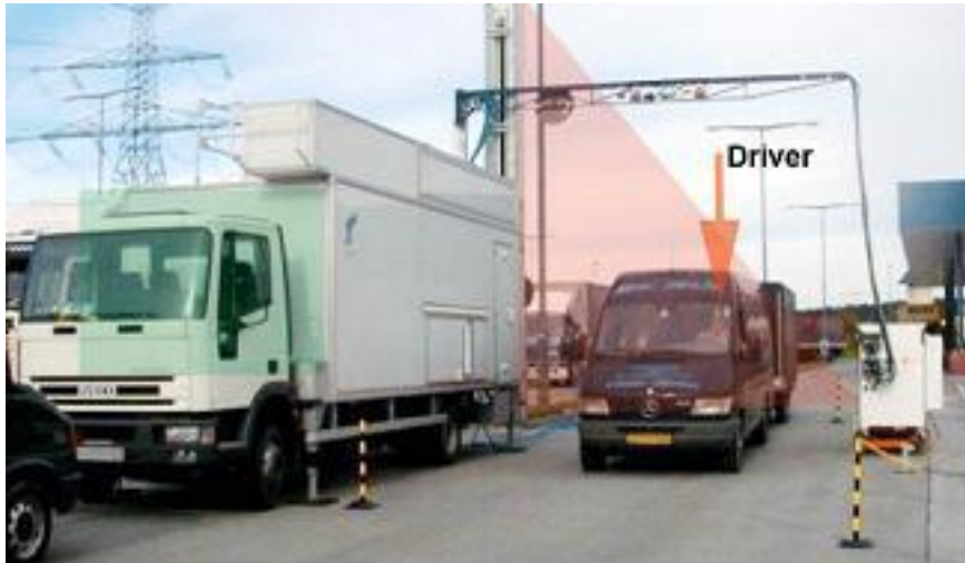
Фотография 2 – Сканер контурного типа – (300 кэВ): рентгеновский инспекционно-досмотровый комплекс с двумя уровнями энергии, работающая в режиме постоянного воздействия. Водитель сидит в кабине и ведет грузовик через арку сканера.
