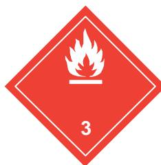
رسم تخطيطي لسائل لهوب في "لائحة الأمم المتحدة التنظيمية النموذجية" (الرمز: لهب: أسود أو أبيض؛ على أرضية: حمراء؛ يكتب الرقم ٣ في الركن الأسفل؛ الأبعاد الدنيا:  $100 \text{ mm} \times 100 \text{ mm}$ )
