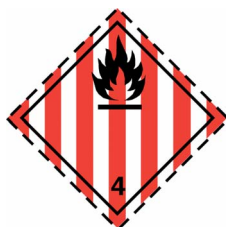
(№ 4.1) Подкласс 4.1 Легковоспламеняющиеся твердые вещества Символ (пламя): черный; фон: белый с семью вертикальными красными полосами; цифра "4" в нижнем углу
