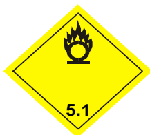
(5.1 号) 5.1 项 氧化性物质 符号(圆圈上面一团火焰): 黑色; 底色: 黄色; 数字“5.1”写在底角
