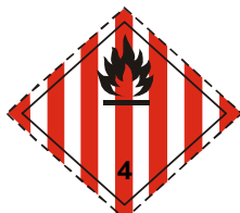
(4.1 号) 4.1 项 易燃固体 符号(火焰): 黑色; 底色: 白色, 带有七条 垂直的红色条纹; 数字“4”写在底角
