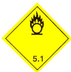
(№ 5.1) Подкласс 5.1 Окисляющие вещества Символ (пламя над окружностью): черный; фон: желтый; цифры "5.1" в нижнем углу
