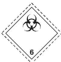
(№ 6.2) Подкласс 6.2 Инфекционные вещества В нижней половине знака могут иметься надписи: "ИНФЕКЦИОННОЕ ВЕЩЕСТВО" и "В случае повреждения или утечки немедленно уведомить органы здравоохранения"; Символ (три полумесяца, наложенные на окружность) и надписи: черные; фон: белый; цифра "6" в нижнем углу
