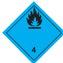
(№ 4.3) Подкласс 4.3 Вещества, выделяющие легковоспламеняющиеся газы при соприкосновении с водой Символ (пламя): черный или белый; фон: синий; цифра "4" в нижнем углу
