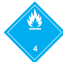
(№ 4.3) Подкласс 4.3 Вещества, выделяющие легковоспламеняющиеся газы при соприкосновении с водой Символ (пламя): черный или белый; фон: синий; цифра "4" в нижнем углу
