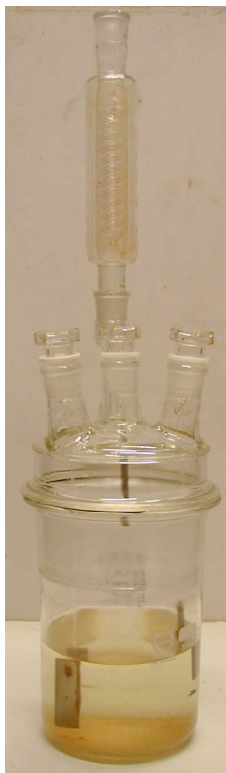
Figure 37.4.2: Réacteur avec réfrigérant à reflux
