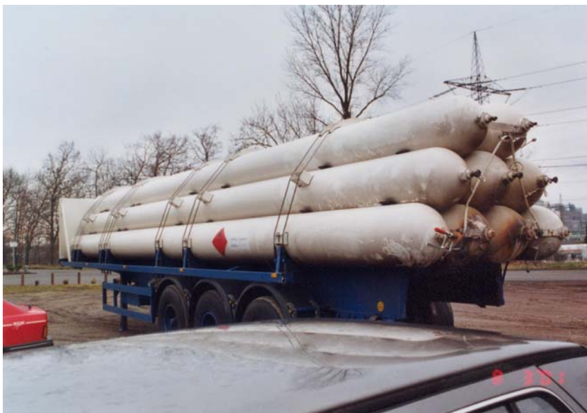
Фотография 2: Транспортное средство-батарея после наезда сзади грузового автомобиля на скорости приблизительно 60 км/ч.
