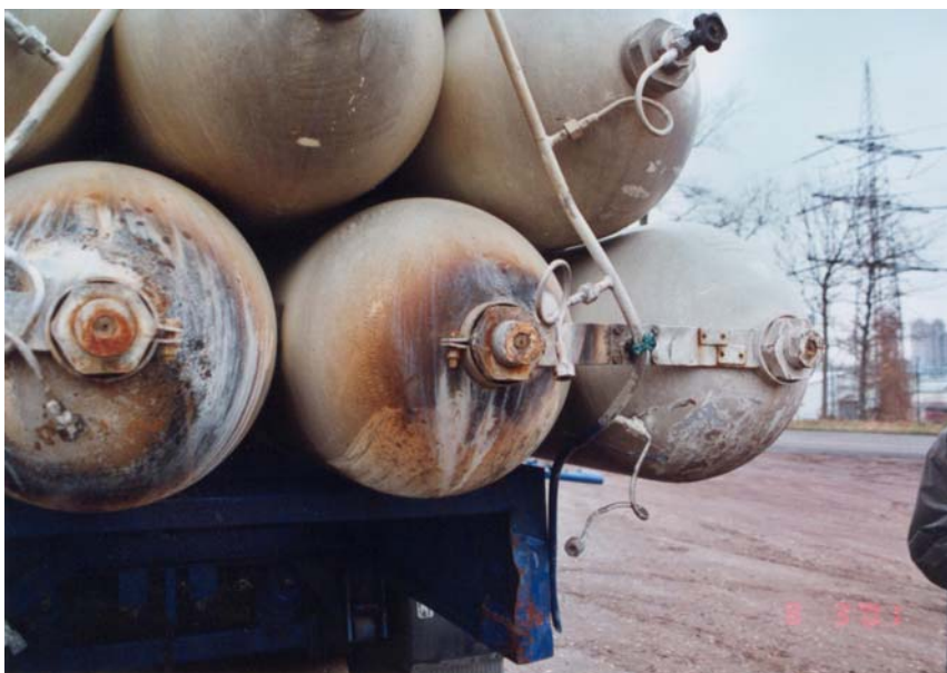
Фотография 3: Транспортное средство-батарея после аварии: вид с близкого расстояния - сорваны первые запорные устройства (латунные клапаны), на поверхности заметны следы воздействия пламени от возгорания водорода.
