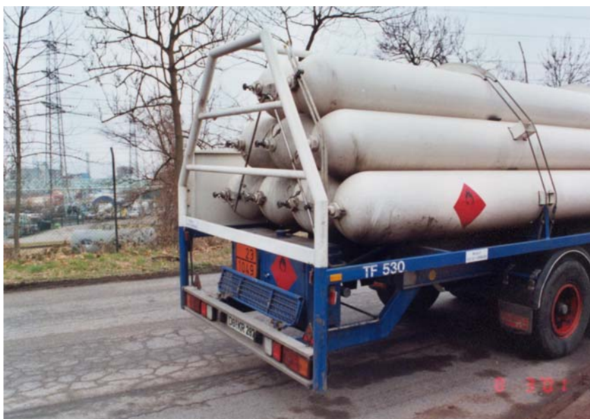
Фотография 1: Транспортное средство-батарея перед аварией: вид сзади с защитной трубной конструкцией.
