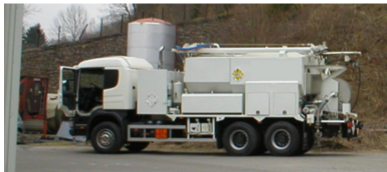
Figure 2: Exemple d'une unité mobile de fabrication d'explosifs
