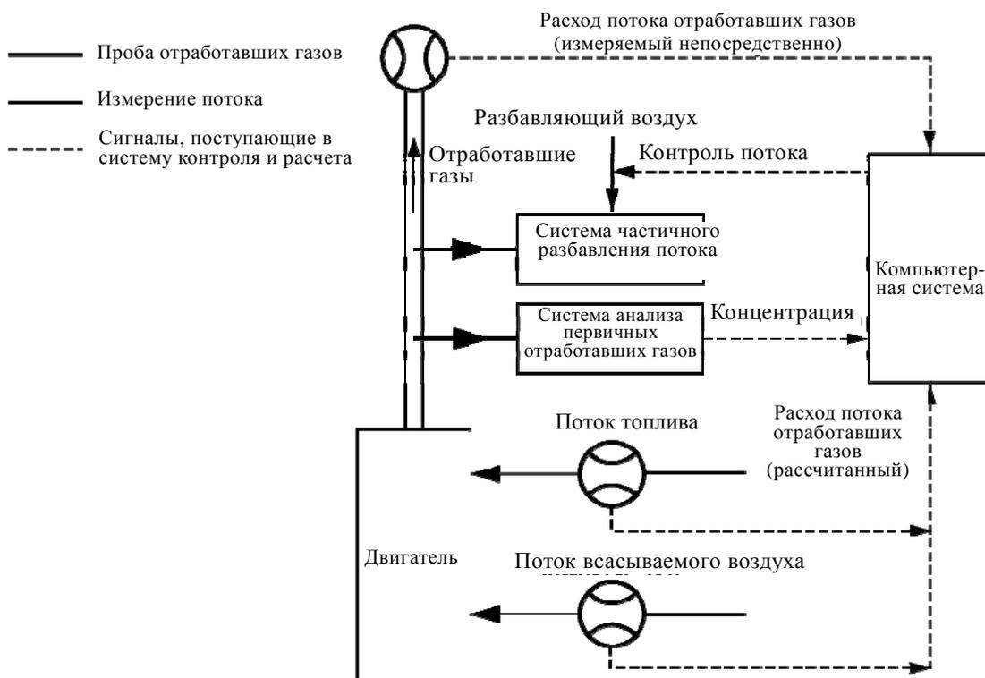
Рис. А.9.4 – Примерная схема системы измерения первичного/частично разбавленного потока
