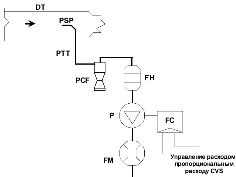
В случае разбавления полного потока пробы разбавленных отработавших газов отбирается из канала для разбавления DT и пропускается через пробоотборник частиц PSP и патрубок отвода частиц PTT с помощью насоса для перекачки проб Р. Проба проходит через предварительный сепаратор (PCF) для "сортировки" частиц по размеру и фильтродержатель(и) FH, в котором (которых) закреплен(ы) фильтр(ы) для осаждения частиц. Расход пробы регулируется с помощью регулятора расхода FC.
