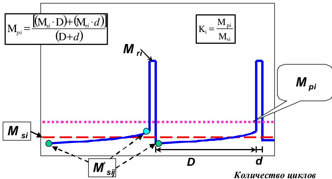
Рис. 8/1: Параметры выбросов в ходе испытания во время циклов регенерации и между ними (схематический пример, выбросы в процессе "D" могут увеличиваться или сокращаться)
