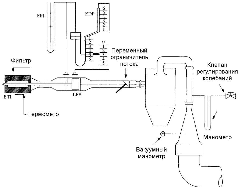
4.2.4.3 Система CVS, имеющая многоскоростной привод, должна калиброваться по каждой используемой скорости. Калибровочные кривые, определенные для диапазона скоростей, должны быть приблизительно параллельными, а величины на координатной оси ( $D_0$ ) должны увеличиваться по мере снижения скорости потока, нагнетаемого насосом.
