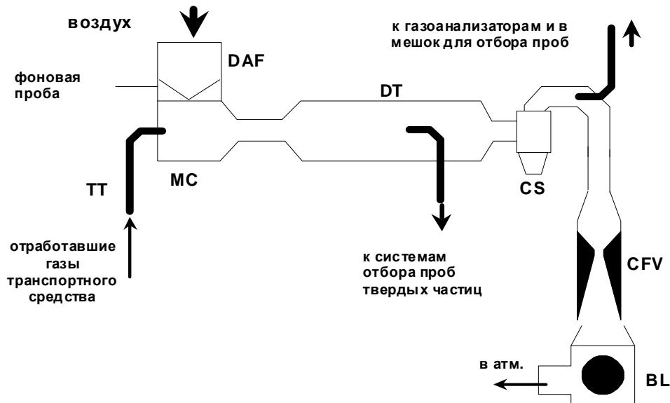
**Система полного разбавления потока с использованием трубы Вентури с критическим расходом**
