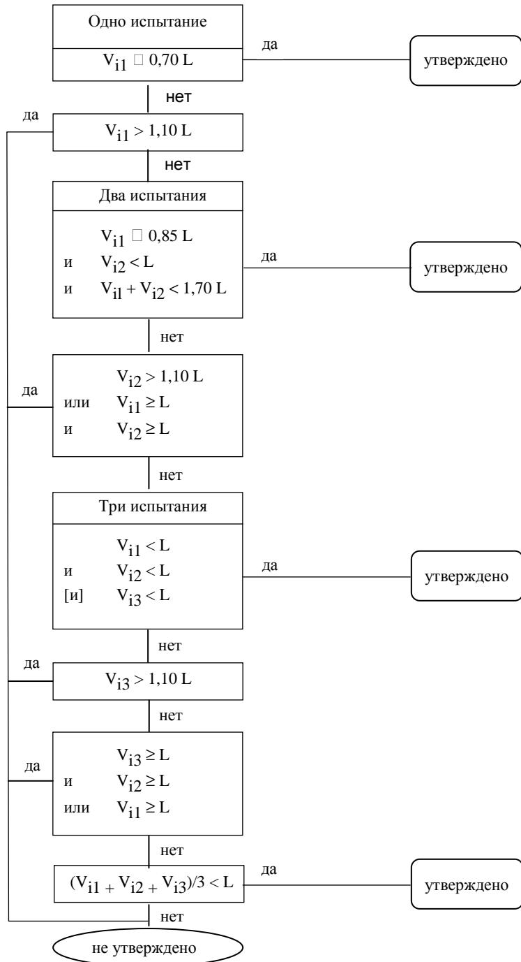
5.3.2 Испытание типа II (выбросы моноксида углерода в режиме холостого хода)
