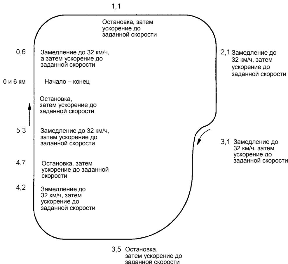
**6.2** Ресурсное испытание или, по выбору завода-изготовителя, измененное ресурсное испытание должно проводиться до тех пор, пока пробег транспортного средства не составит минимум **160 000** км.
