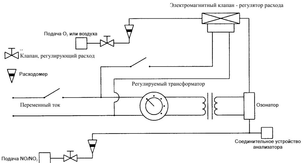
2.4.6 С отключением озонатора перекрывается также поток кислорода или синтетического воздуха. При этом значение NO<sub>2</sub>, показываемое анализатором, должно не более чем на 5% превышать значение, указанное в пункте 2.4.1 выше.
