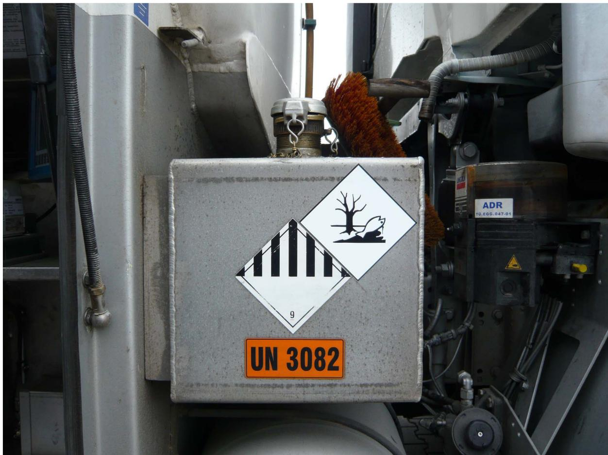
Illustration: système pour additifs moderne monté sur le système de distribution d'un véhicule-citerne pour huile de chauffe
