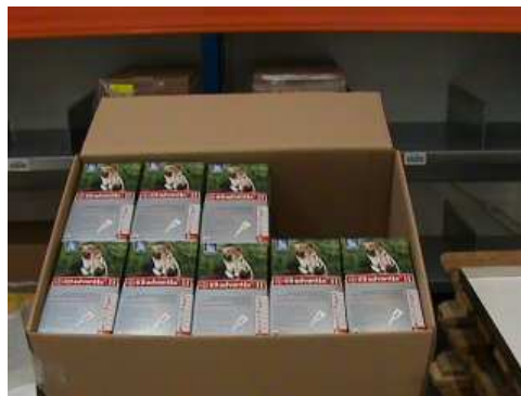
Photo 2: Caisse remplie d'emballages intérieurs ayant reçu un volume total de 1,920 ml d'eau
