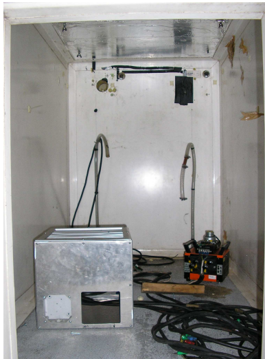
Calorimètre avec groupe à gaz liquéfié en essai
