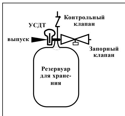
Рис. 1 Типичная система хранения компримированного водорода
