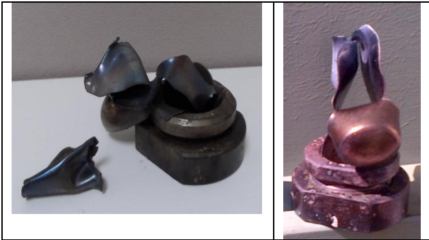
«F»: Douille fragmentée en trois morceaux ou plus, assez gros pour la plupart, éventuellement restés attachés entre eux
