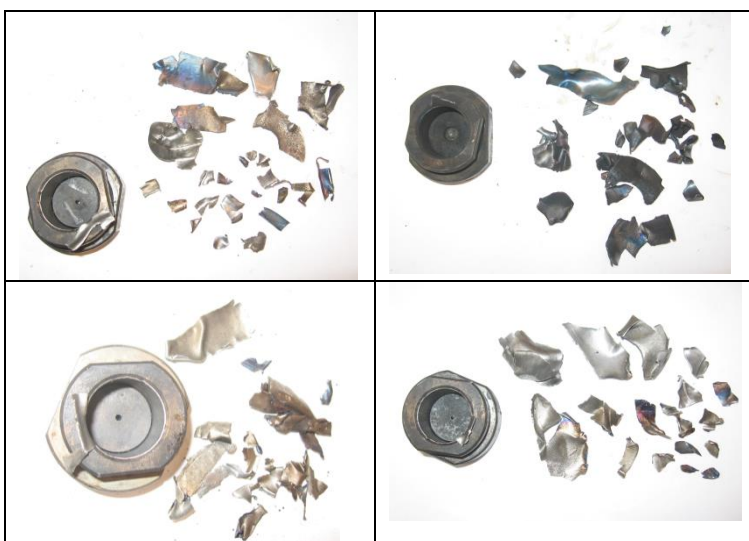
«G»: Douille fragmentée en de nombreux morceaux, petits pour la plupart, dispositif de fermeture intact
