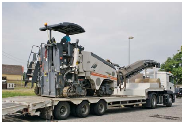
Petite fraiseuse routière sur un véhicule de transport
