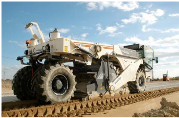
Recycleur à froid/engin de stabilisation en action
