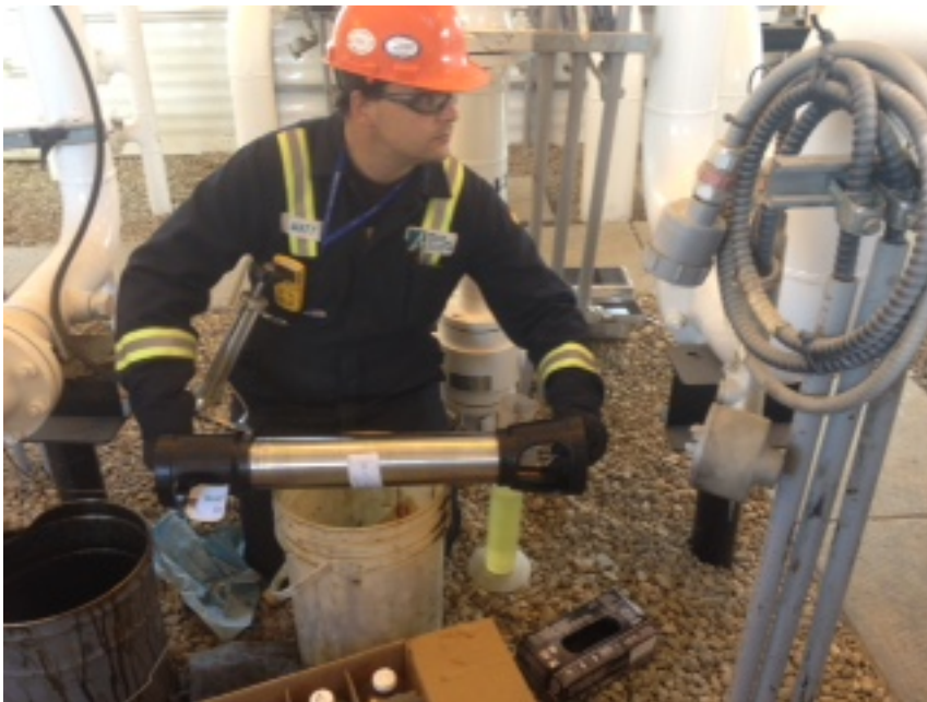
Figure 4 : Collecte d'échantillon pressurisé à un terminal routier
