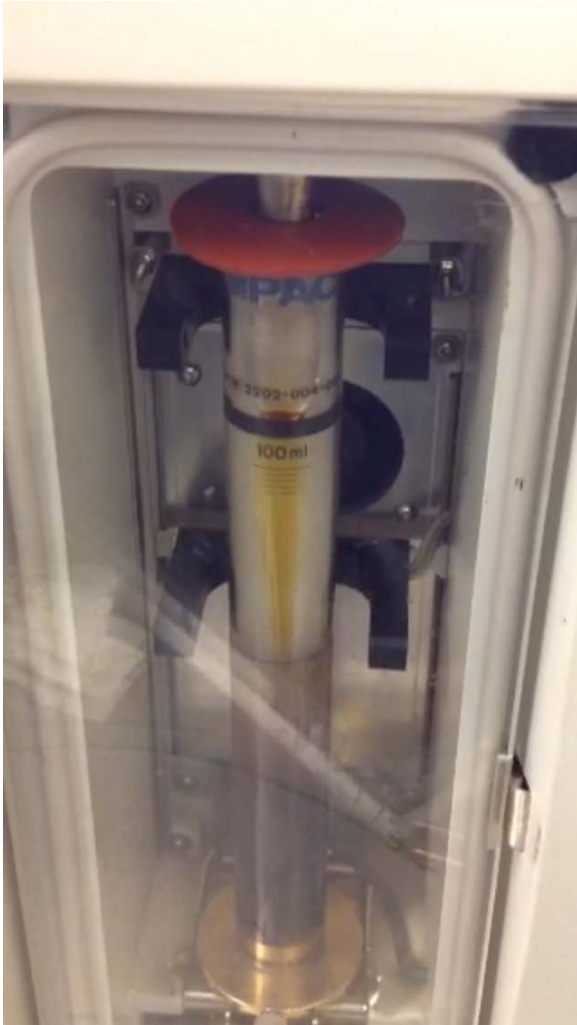
Figure 28 : Distillation d'un échantillon de DILBIT (FL14_1881-007) par la méthode ASTM D86
