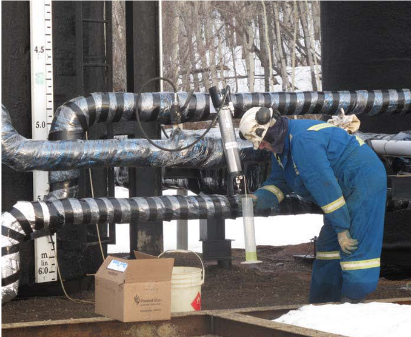
Figure 3 : Collecte d'échantillon pressurisé dans un parc de stockage
