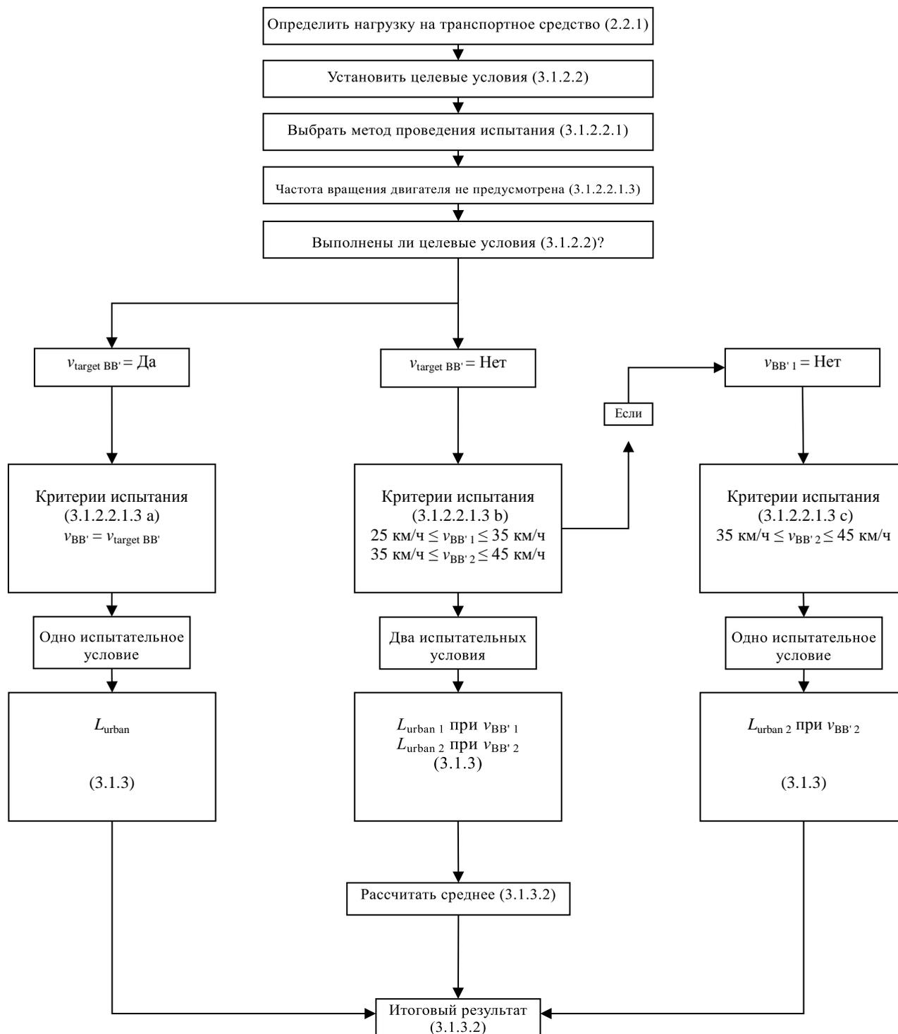
Расширение диапазона целевой скорости транспортного средства  $v_{\text{target BB}'}$  в случае транспортных средств категории  $M_2$ , имеющих технически допустимую массу в груженом состоянии более 3 500 кг, и транспортных средств категорий  $N_2$ ,  $M_3$  и  $N_3$
