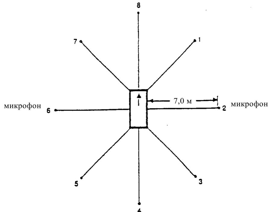
Измерение проводят на неподвижном транспортном средстве, как показано на рис. 1, с использованием двух микрофонов, расположенных на расстоянии 7 м от контура транспортного средства и на высоте 1,2 м над уровнем грунта.
