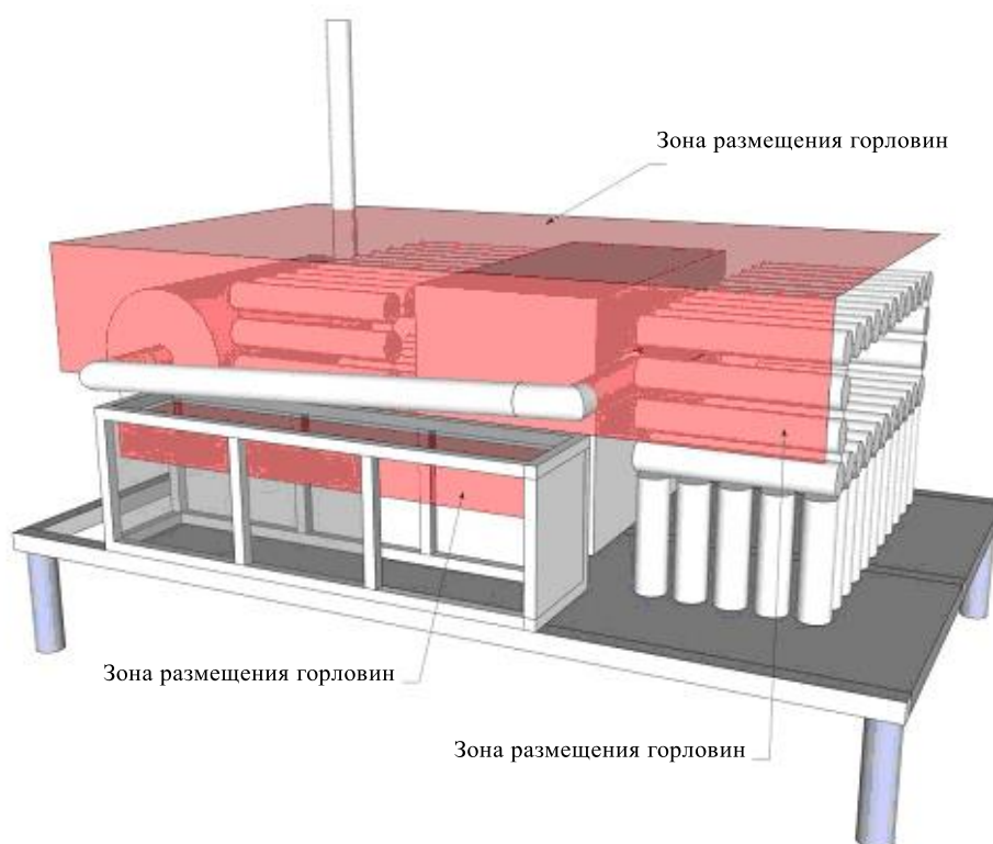
Рис. 11 Расположение горловин (вид сзади испытательного устройства)
