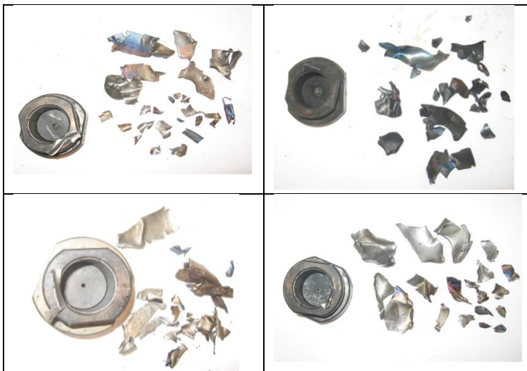
"G": Трубка разорвалась на множество в основном мелких кусков; закрывающее устройство осталось неповрежденным
