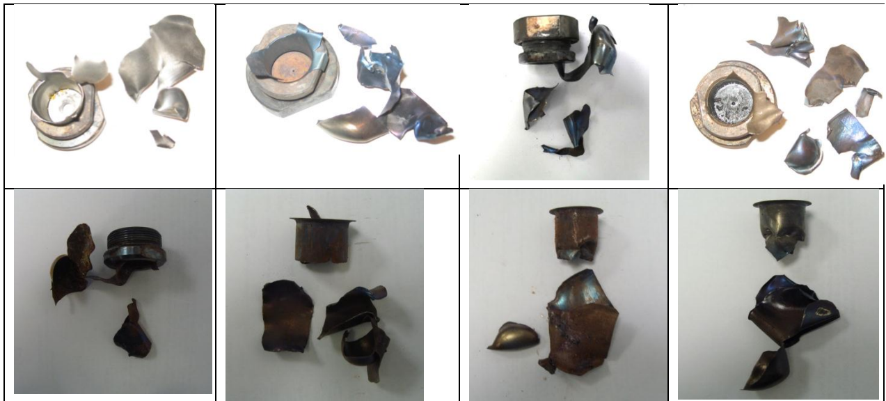
"G": Трубка разорвалась на множество в основном мелких кусков; закрывающее устройство осталось неповрежденным
