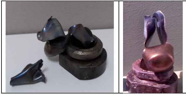
"F": Трубка разорвалась на три или более в основном крупных куски, между которыми в некоторых случаях могут оставаться узкие перемычки;
