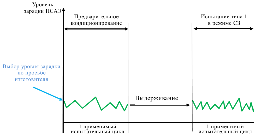
Рис. А8.Аpp1/5 ГЭМ-БЗУ и ГТСТЭ-БЗУ, испытание типа 1 в режиме сохранения заряда
