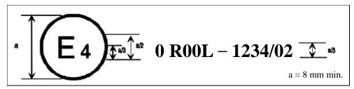
La marque d'homologation ci-dessus, apposée sur un véhicule, indique que la classe IWVTA a fait l'objet d'une homologation de statut limité délivrée aux Pays-Bas (E 4), en application de la version initiale du présent Règlement. La lettre L indique qu'il s'agit d'une homologation de statut limité (par. 2.3.2 du présent Règlement). L'homologation est accordée pour la classe IWVTA homologuée sous le numéro 1234 et le type IWVTA homologué sous le numéro 02.
