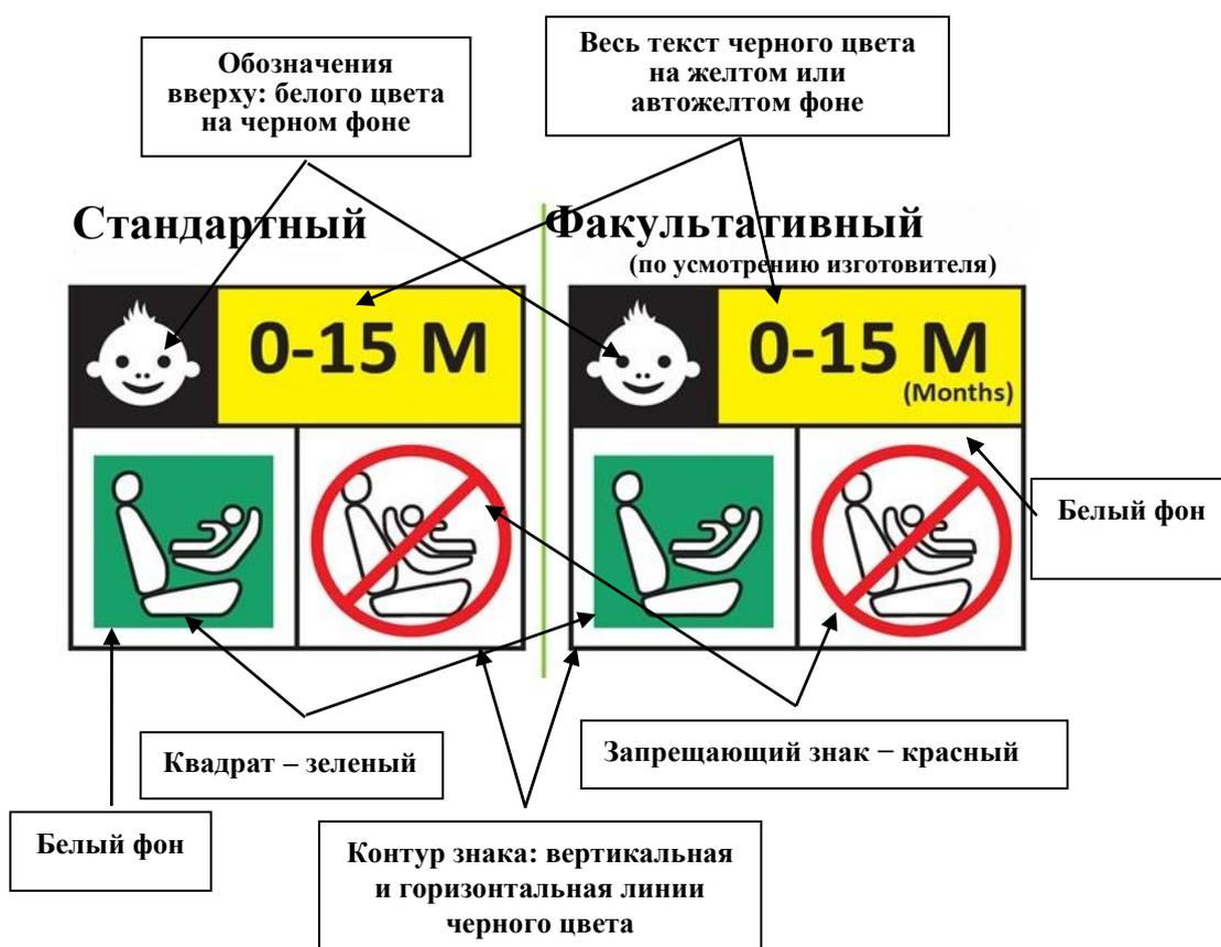
На усовершенствованных детских удерживающих системах цельной конструкции, которые могут использоваться только в направлении движения, предусматривается следующий нестираемый знак (на той части, где размещается ребенок), который должно видеть лицо, устанавливающее усовершенствованную детскую удерживающую систему в транспортном средстве:
