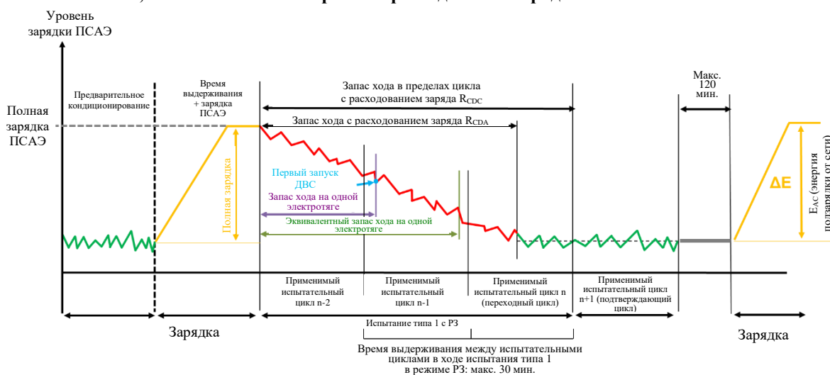
Рис. А8.App1/1 ГЭМ-ВЗУ, испытание типа 1 в режиме расходования заряда
