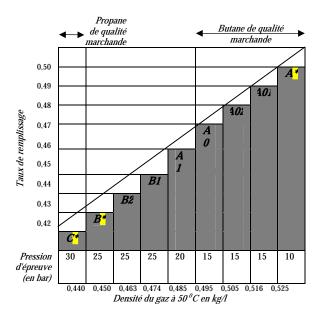
Par exemple, pour des densités comprises entre 0,505 kg/l et 0,516 kg/l, et un récipient à pression soumis à une pression d'épreuve de 15 bar, le taux de remplissage est de 0,48.
