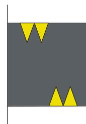
Рис. 3 Искусственная неровность, обозначенная с помощью линий
