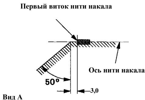
Рис. 4 Зона без металлических частей 6/
