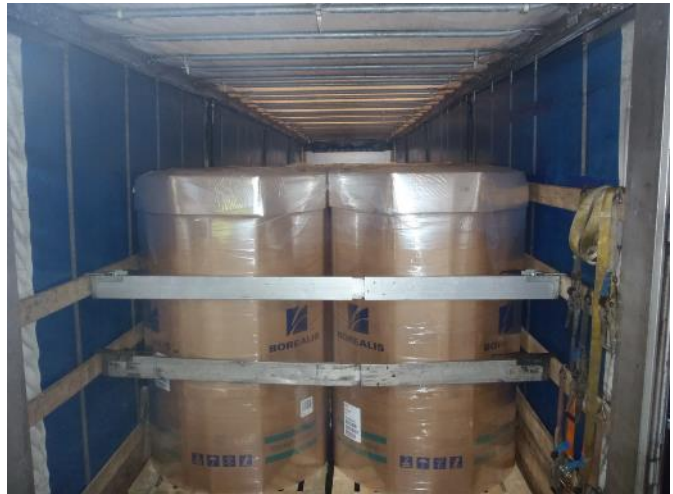
Figure 7.15 – Traverses servant à l'immobilisation présentant une résistance limitée en raison de l'assujettissement direct
