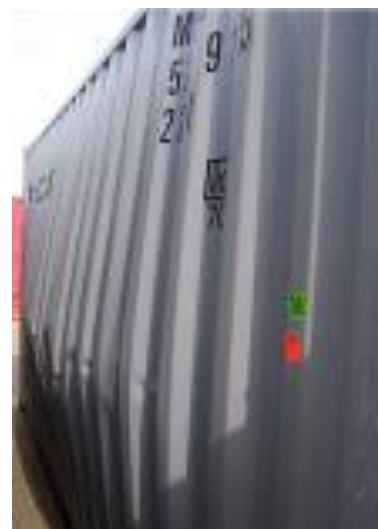
Figure 7.68 — Paroi latérale endommagée pendant un transport par route
