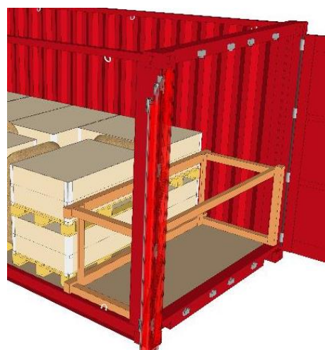
Figure 7.50 – Poutres transversales insérées dans les cannelures soutenues par des poutres d'accorage placées contre les charnières des portes
