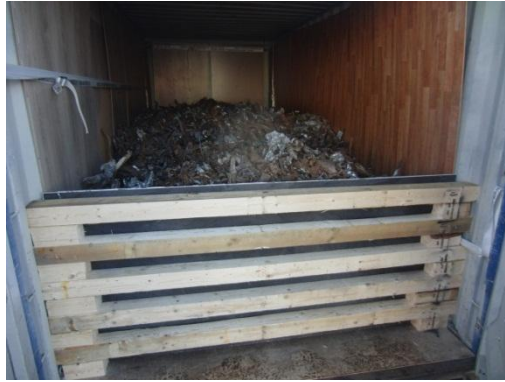
Figure 7.5576 – Engin de transport chargé rempli de ferraille doté d'une doublure au niveau des parois et d'une barrière de porte
