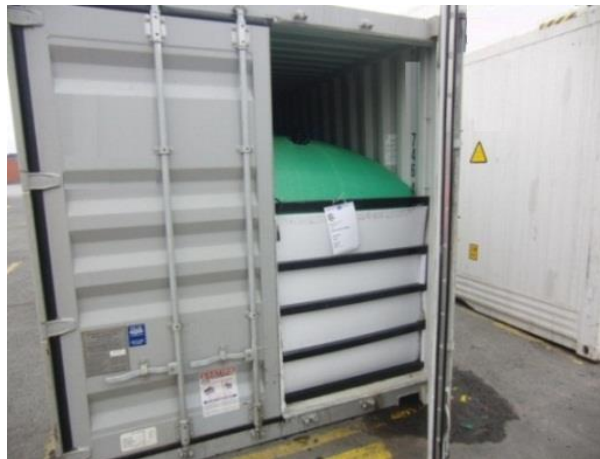
Figure 7.5167 – Conteneur équipé d'une citerne souple
