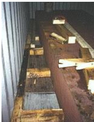
Figure 7.4561 – Immobilisation transversale de plaques d'acier
