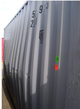
Figure 7.70 – Renflement de la paroi
