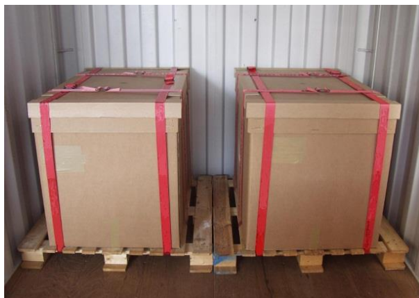
Figure 7.811 – Cargaison solidement assujettie à des palettes au moyen de saisines en textile
