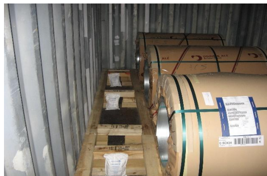
Figure 7.40 – Dispositif d'immobilisation placé contre l'entourage
