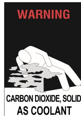
Figure 5.19 – Étiquette signalant une atmosphère dangereuse
