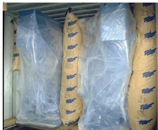
Figure 7.4013 – Colis de forme irrégulière sans arêtes vives immobilisés à l'aide de sacs de fardage
