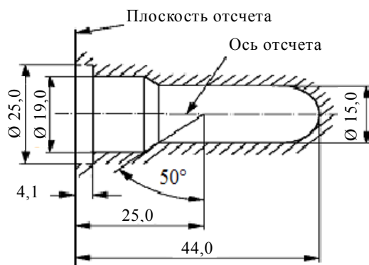
Рис. 2 Максимальные контуры источника света с нитью накала 3/
